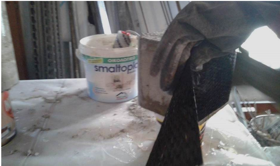
Εικόνα 6.23 Εφαρμογή υφάσματος CFRP σε κυλινδρικό δοκίμιο
