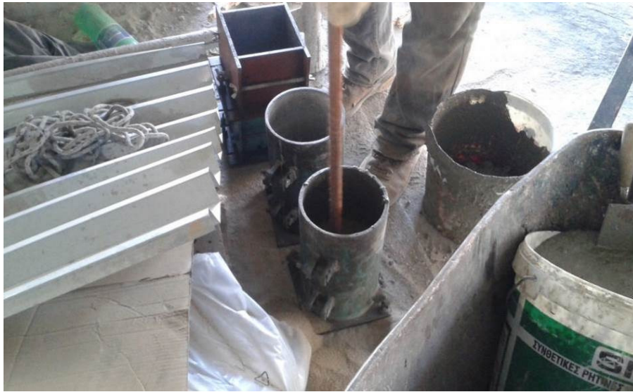
Εικόνα 6.3 Δόνηση κυλινδρικού δοκιμίου με μπετόβεργα.
