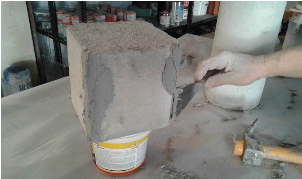
Εικόνα 6.16 Εφαρμογή εποξειδικής ρητίνης ως στρώση ασταρώματος
