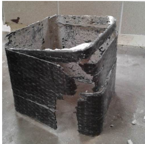
Εικόνα 7.8 Μανδύας CFRP μετά την θλίψη κυβικού δοκιμίου
