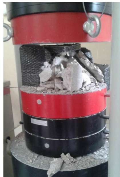
Εικόνα 7.7 Κυβικό δοκίμιο με CFRP πριν και μετά την υποβολή του σε κεντρική μονοαξονική θλίψη
