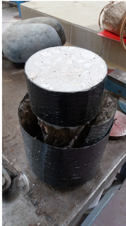
Εικόνα 7.13 Μανδύας CFRP μετά την θλίψη κυλινδρικού δοκιμίου
