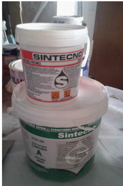
Εικόνα 5.4 Εποξειδική ρητίνη δύο συστατικών S2W ως στρώση ασταρώματος (priming coat)
