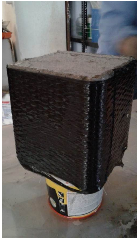
Εικόνα 6.28 Έτοιμο κυβικό δοκίμιο 2ης ομάδας με διπλή στρώση CFRP
