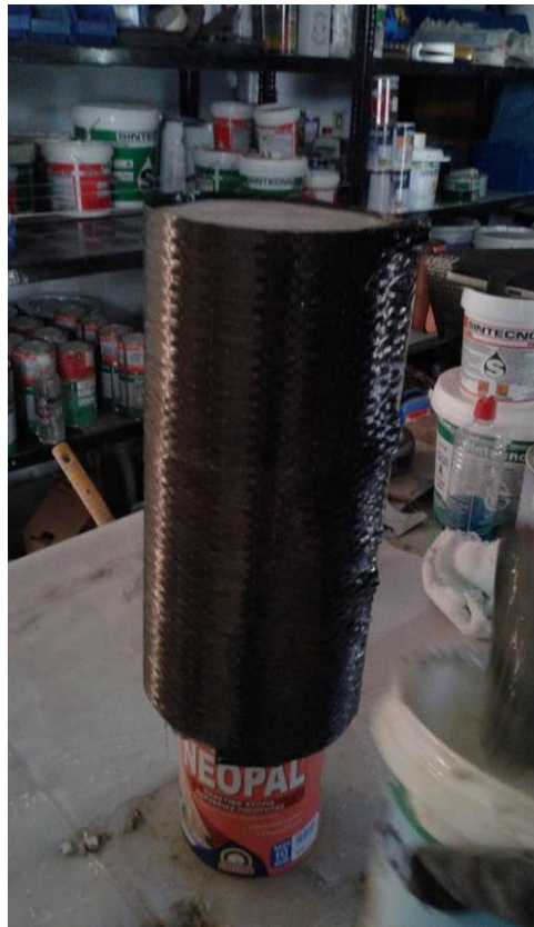
Εικόνα 6.34 Κυλινδρικό δοκίμιο 4ης ομάδας με διπλή στρώση CFRP
