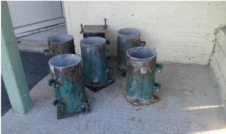
Εικόνα 6.1 Μήτρες κυλινδρικών δοκιμίων διαμέτρου 15cm και ύψους 30cm.
