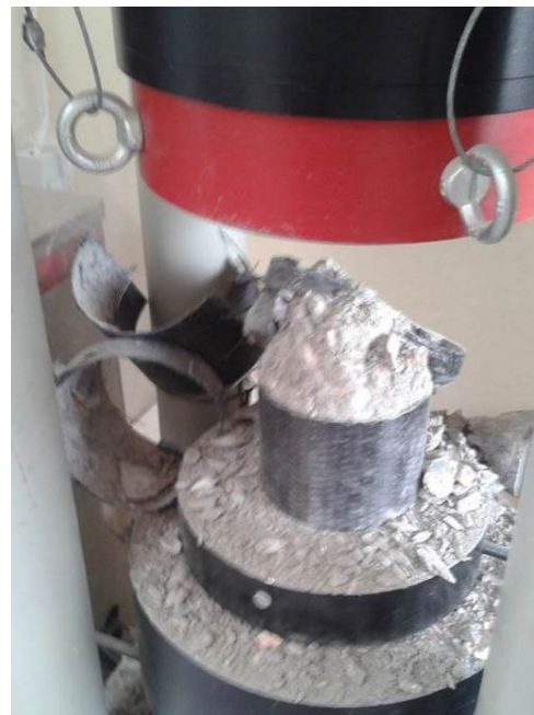
Εικόνα 7.12 Κυλινδρικό δοκίμιο με CFRP πριν και μετά την υποβολή του σε κεντρική μονοαξονική θλίψη
