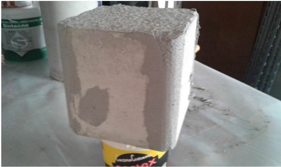
Εικόνα 6.18 Κυβικό δοκίμιο μετά από αστάρωμα με εποξειδική ρητίνη Sinmast S2W
