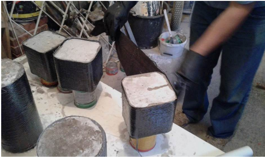
Εικόνα 6.27 Εφαρμογή 2ης στρώσης υφάσματος CFRP σε κυβικό δοκίμιο
