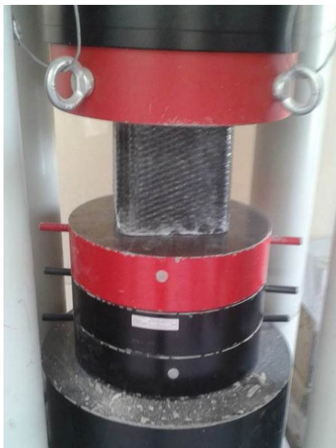
Εικόνα 7.7 Κυβικό δοκίμιο με CFRP πριν και μετά την υποβολή του σε κεντρική μονοαξονική θλίψη
