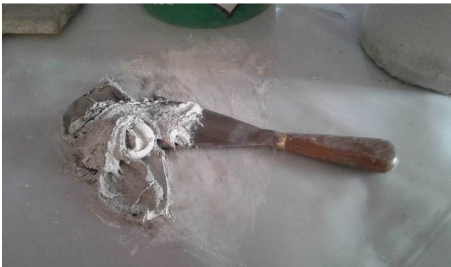
Εικόνα 6.15 Ανάμειξη εποξειδικής ρητίνης δύο συστατικών Sinmast S2W
