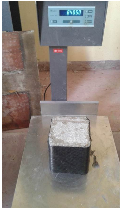
Εικόνα 7.6 Ζύγιση κυβικού δοκιμίου με CFRP
