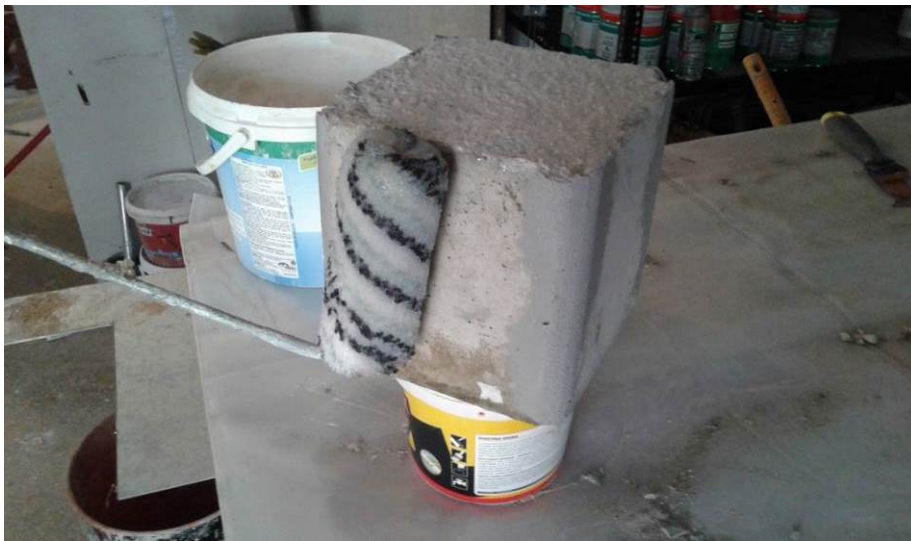
Εικόνα 6.21 Εφαρμογή εποξειδικής ρητίνης δύο συστατικών Sinmast S2WV σε κυβικό δοκίμιο ως μέσο επικόλλησης
