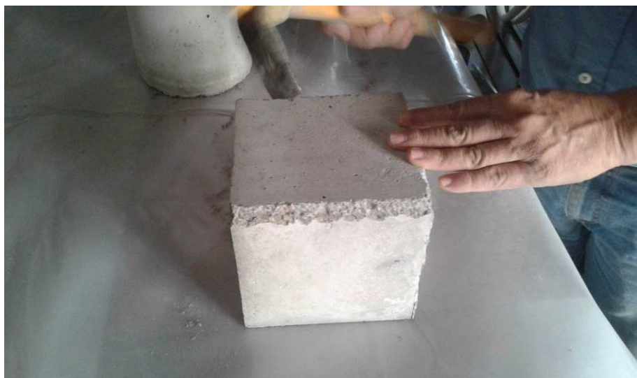
Εικόνα 6.10 Άμβλυνση γωνιών κυβικού δοκιμίου με σφυράκι
