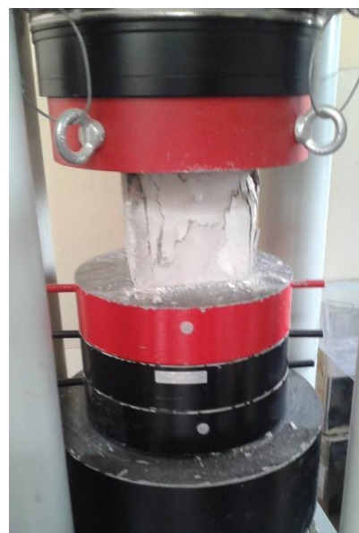
Εικόνα 7.4 Κυβικό δοκίμιο πριν και μετά την υποβολή του σε κεντρική μονοαξονική θλίψη
