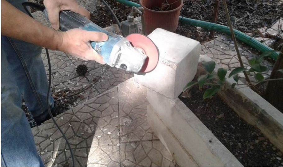
Εικόνα 6.11 Λείανση γωνιών κυβικού δοκιμίου με τροχό
