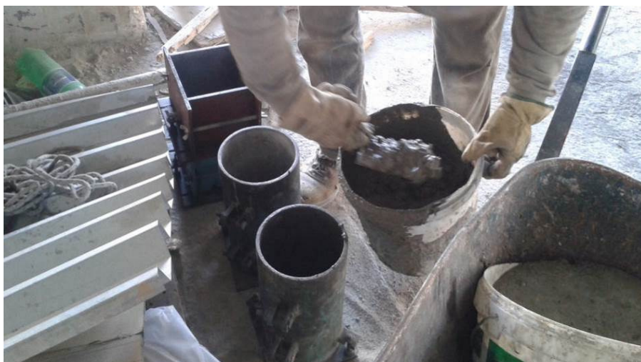
Εικόνα 6.2 Λήψη δοκιμίων σκυροδέματος C30/37
