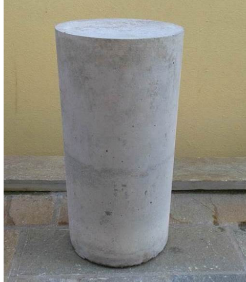
Εικόνα 6.29 Δοκίμιο 3ης ομάδας, κυλινδρικό διαμέτρου 15cm και ύψους 30cm
