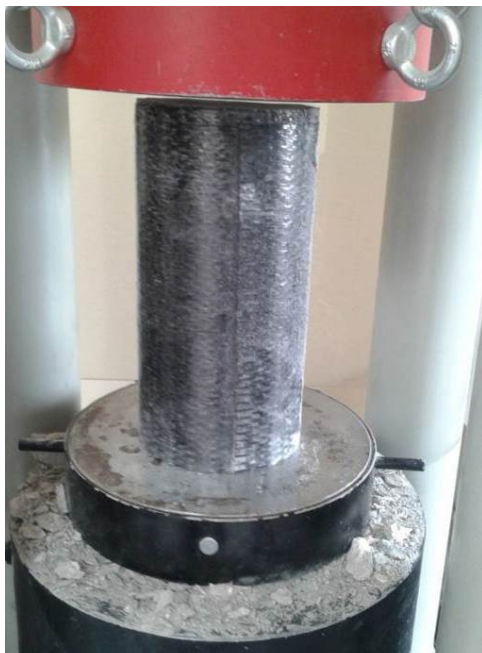
Εικόνα 7.12 Κυλινδρικό δοκίμιο με CFRP πριν και μετά την υποβολή του σε κεντρική μονοαξονική θλίψη
