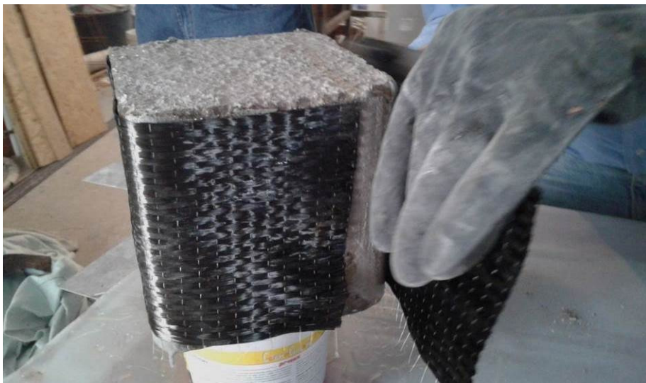
Εικόνα 6.24 Αγκύρωση – μάτιση υφάσματος CFRP σε κυβικό δοκίμιο
