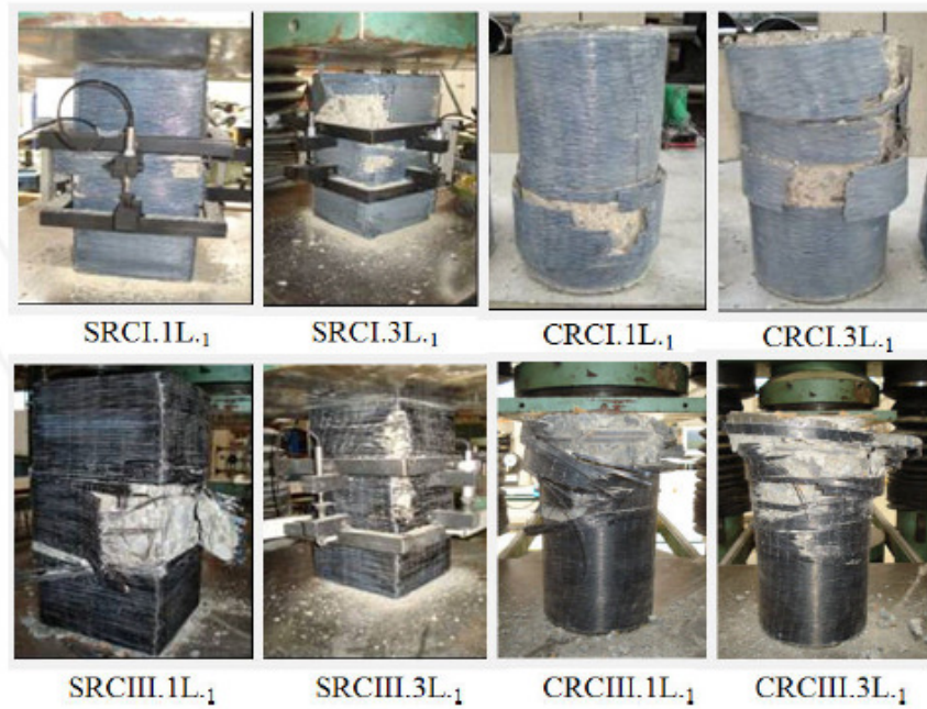
Εικόνα 2.2 Δοκίμια μετά την εκτέλεση του πειράματος [29]
