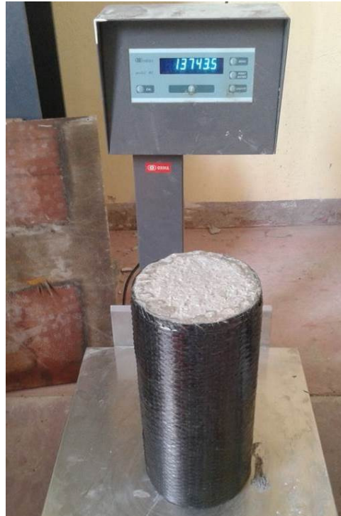
Εικόνα 7.11 Ζύγιση κυλινδρικού δοκιμίου με CFRP
