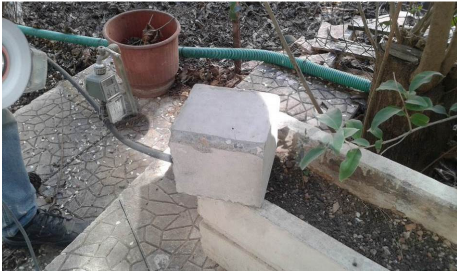
Εικόνα 6.12 Όψη κυβικού δοκιμίου με λειασμένες – στρογγυλεμένες γωνίες
