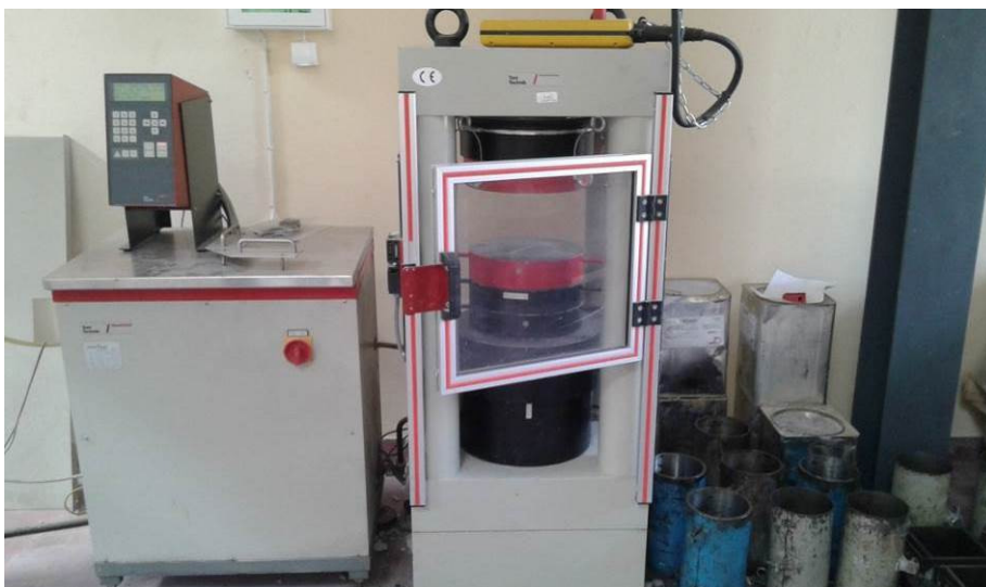
Εικόνα 7.2 Μηχανή θλίψης εργαστηρίου οπλισμένου σκυροδέματος
