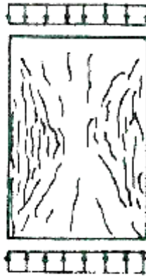
Σχήμα 5.1 Χαρακτηριστική μορφή θραύση από φόρτιση σε κεντρική μονοαξονική θλίψη [20]
