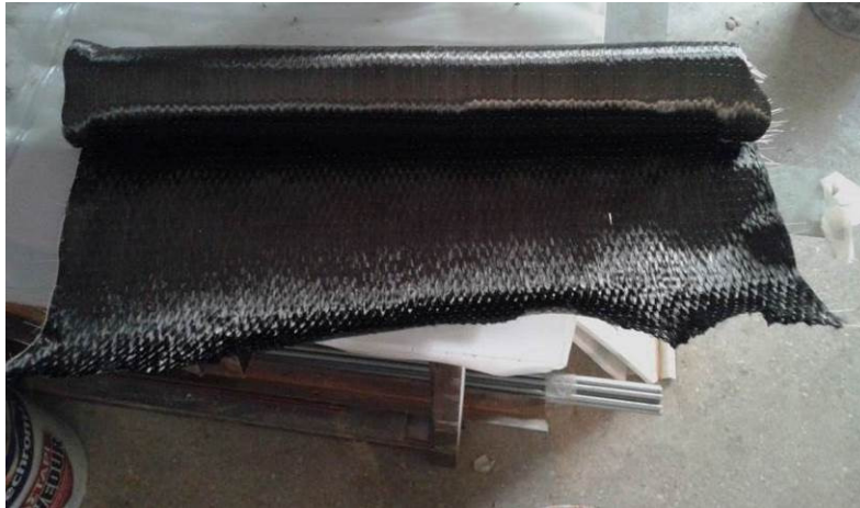
Εικόνα 5.5 FRP S&P C-Sheet 240, 430gr/m 2
