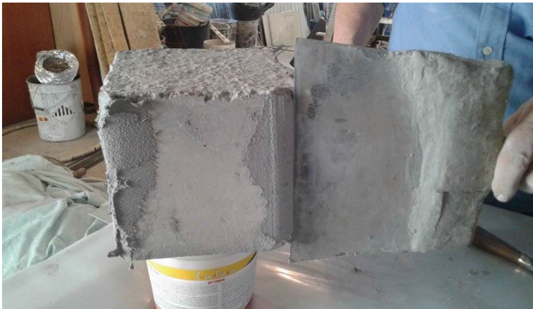
Εικόνα 6.17 Εφαρμογή εποξειδικής ρητίνης ως στρώση ασταρώματος για την επικάλυψη ατελειών
