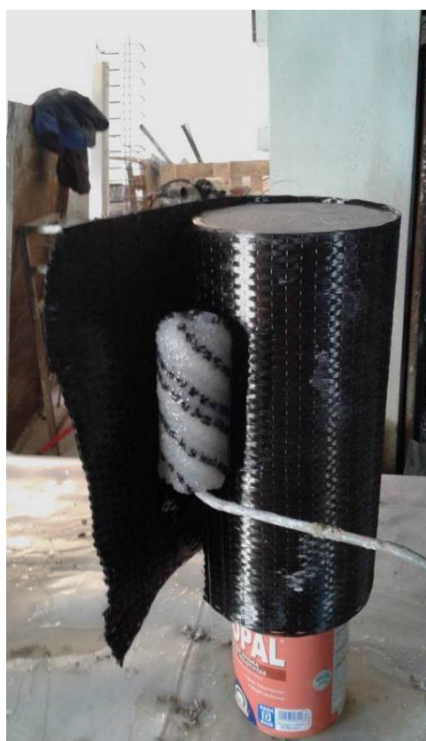
Εικόνα 6.33 Αγκύρωση – μάτιση υφάσματος CFRP σε κυλινδρικό δοκίμιο
