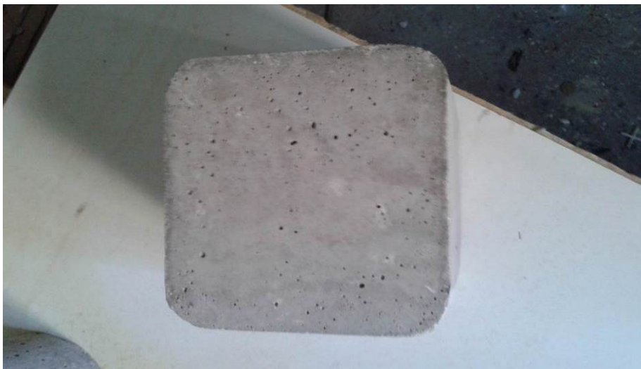
Εικόνα 6.13 Κάτοψη κυβικού δοκιμίου με λειασμένες – στρογγυλεμένες γωνίες
