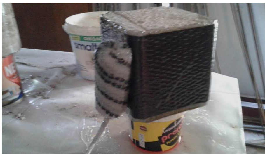
Εικόνα 6.25 Επάλειψη με εποξειδική ρητίνη δύο συστατικών Sinmast S2WV μετά την εφαρμογή της 1ης στρώσης υφάσματος CFRP
