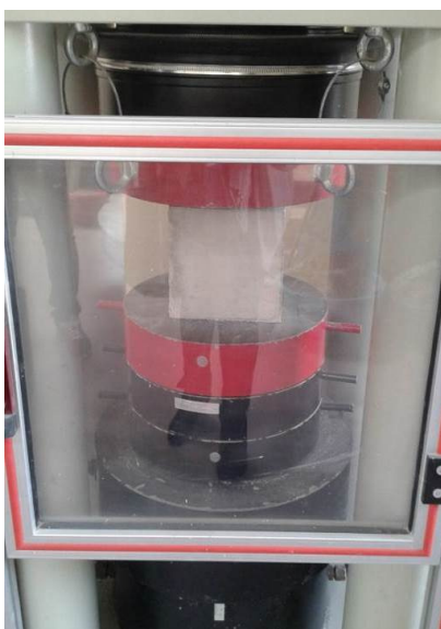
Εικόνα 7.4 Κυβικό δοκίμιο πριν και μετά την υποβολή του σε κεντρική μονοαξονική θλίψη
