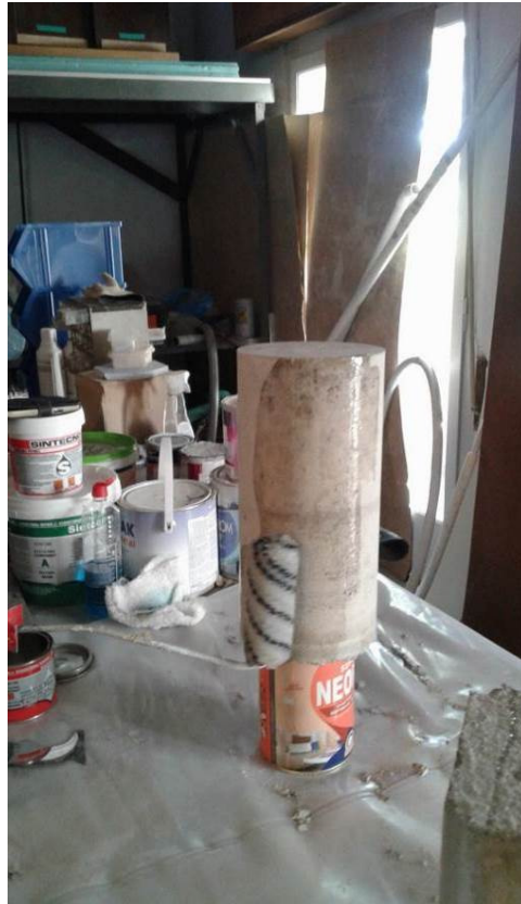
Εικόνα 6.30 Εφαρμογή εποξειδικής ρητίνης δύο συστατικών Sinmast S2WV σε κυλινδρικό δοκίμιο ως μέσο επικόλλησης
