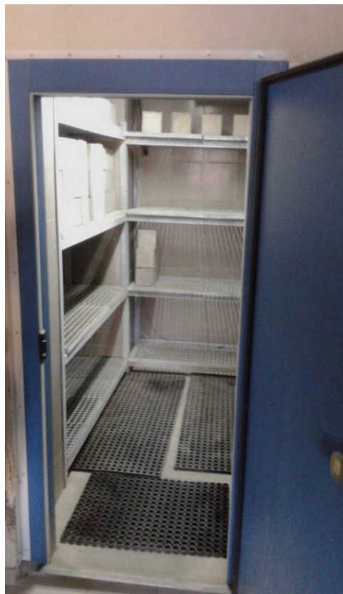
Εικόνα 6.5 Ειδικός χώρος φύλαξης – διατήρησης των δοκιμίων μέχρι την 28η μέρα
