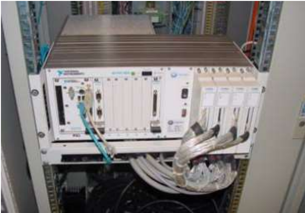
Σχήμα 3-39 Συσσκευή ψηφιοποιήσεις σήματος
