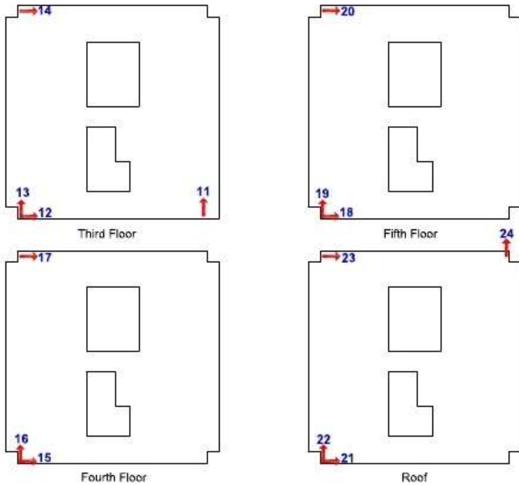
Σχήμα 3-7 Ενοργανωμένες κατόψεις κτιρίου Μεμψις
