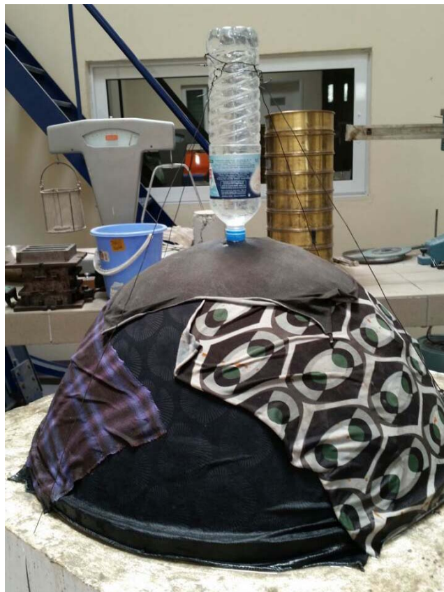
Εικόνα 57.Αυτοσχέδιος τρόπος ποτίσματος τρούλου με μπουκάλι
