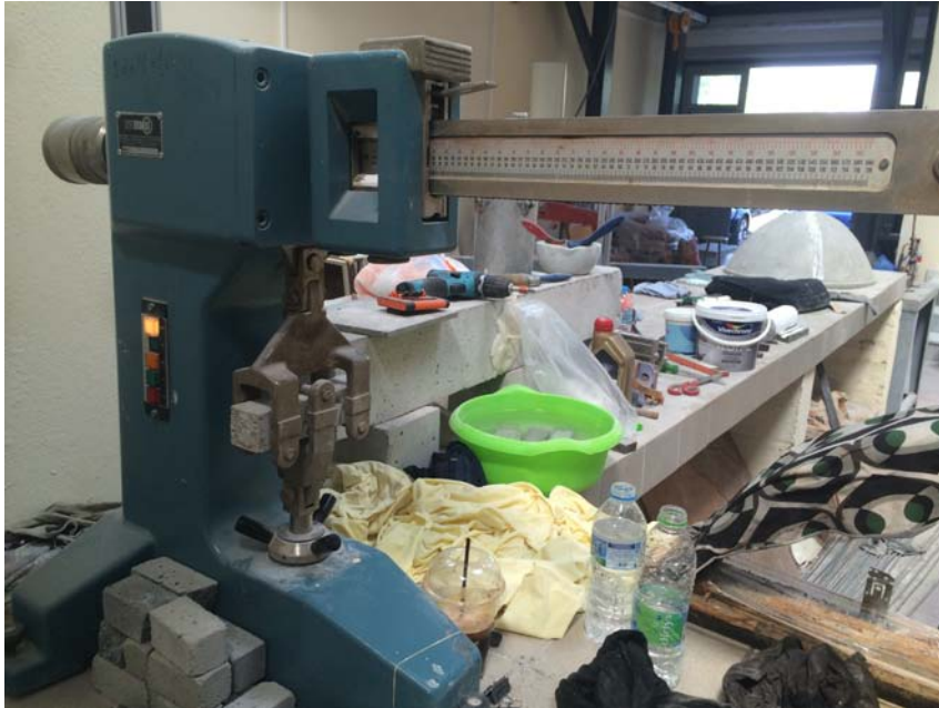
Εικόνα 28. Έλεγχος κάμψης ορθογωνικών δοκιμίων (Πριν την θραύση)
