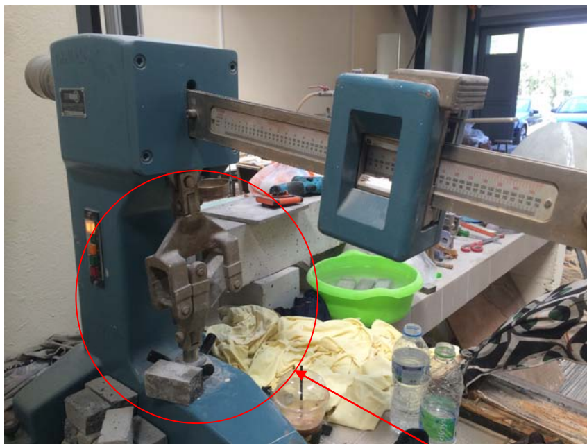
Εικόνα 29. Έλεγχος κάμψης ορθογωνικών δοκιμίων (Μετά την θραύση)
