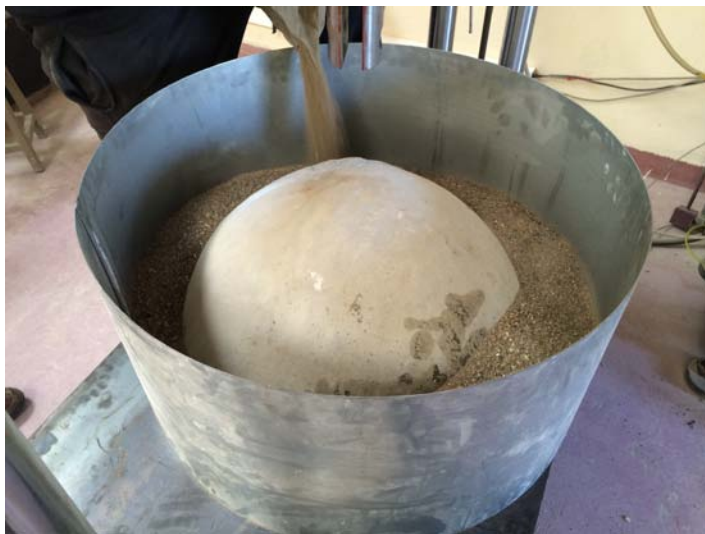
Εικόνα 61.Σταδιακό γέμισμα του εξωτερικού τσερκιού με άμμο για καλύτερη κατανομή των φορτίων
