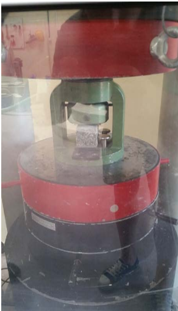
Εικόνα 30. Έλεγχος θλίψης κυβικών δοκιμίων στην COM-TECHNIK
