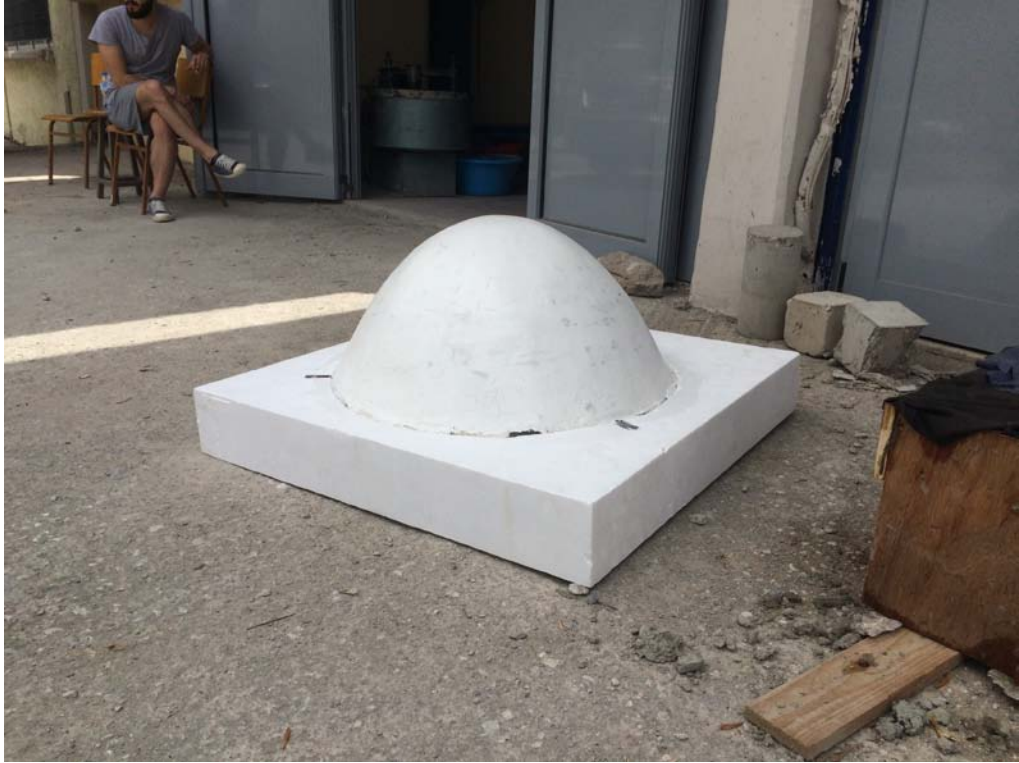
Εικόνα 45. Το τελικό καλούπι μετά απο τρίψιμο των στόκων
