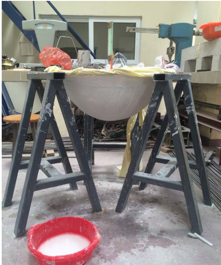
Εικόνα 41. Πέρασμα ελαστικού πανιού με γάζες γύψου για σκλήρυνση του καλουπιού
