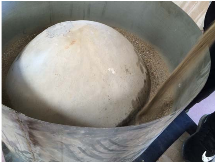
Εικόνα 61.Σταδιακό γέμισμα του εξωτερικού τσερκιού με άμμο για καλύτερη κατανομή των φορτίων
