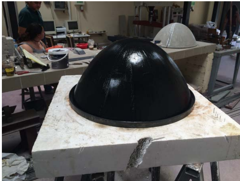
Εικόνα 48.Πέρασμα ταινίας και γράσσου για ευκολία στο ξεκαλούπωμα
