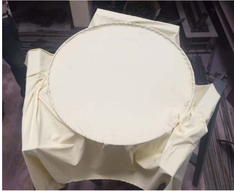
Εικόνα 34. Δέσιμο ελαστικού πανιού στο τσέρκι
