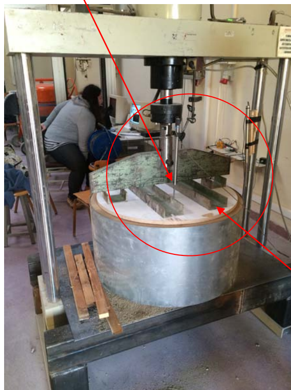
Εικόνα 63.Κλείσιμο περιμετρικού τσερκιού με διπλό καπάκι ξύλινο και τοποθέτηση μεταλλικών δοκών U κάθετα στο ψαλίδι της πρέσας
