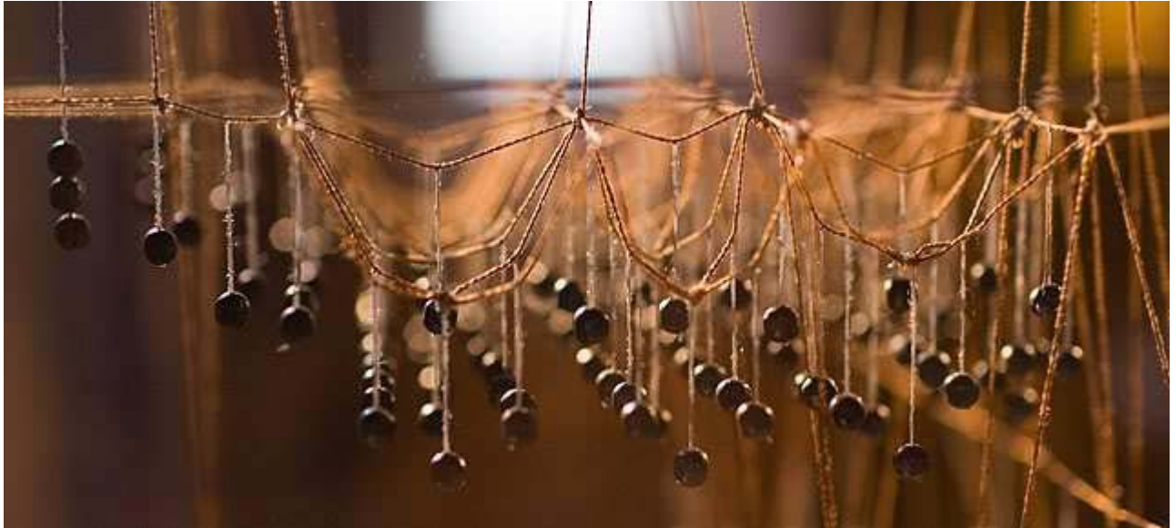
Εικόνα 7.Βελτιστοποιημένα τόξα με τη μέθοδο των κρεμαστών φορτίων
