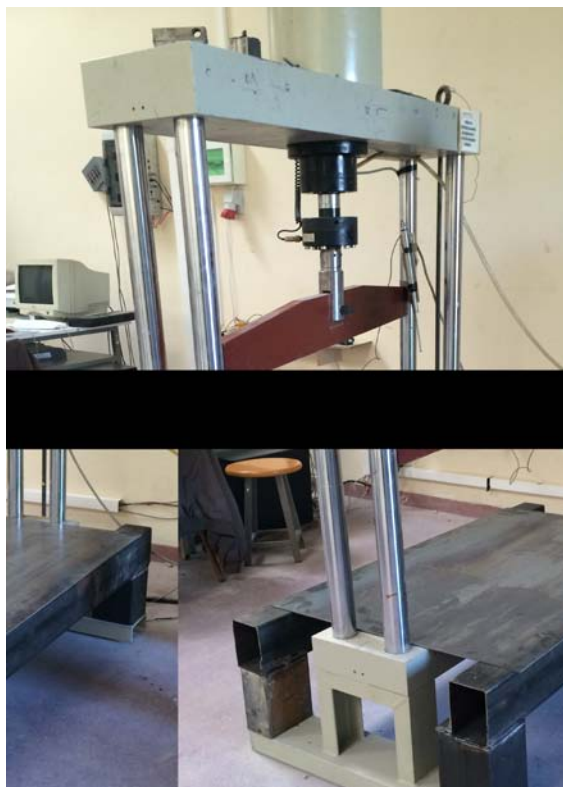
Εικόνα 59.Επέκταση της βάσης της πρέσας θλίψης με κοιλοδοκούς
