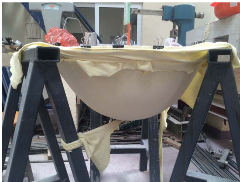
Εικόνα 39.Γέμισμα και χτύπημα της ελαστικής βάσης για το καλύτερο δυνατό-βέλτιστο σχήμα
