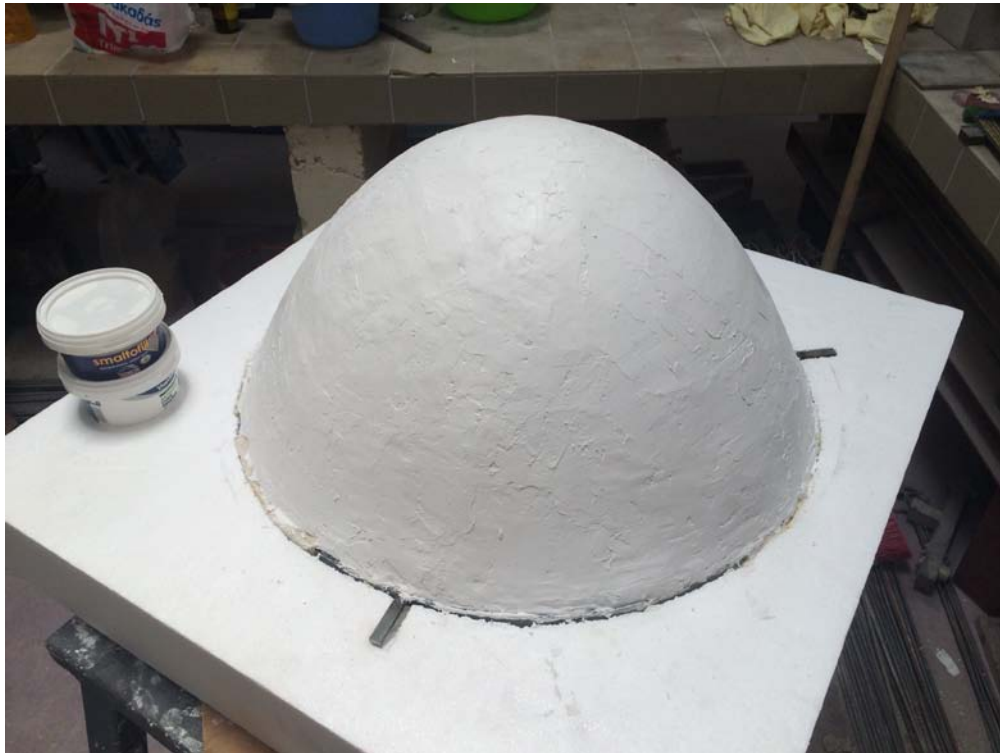
Εικόνα 44.Στοκάρισμα του καλουπιού
