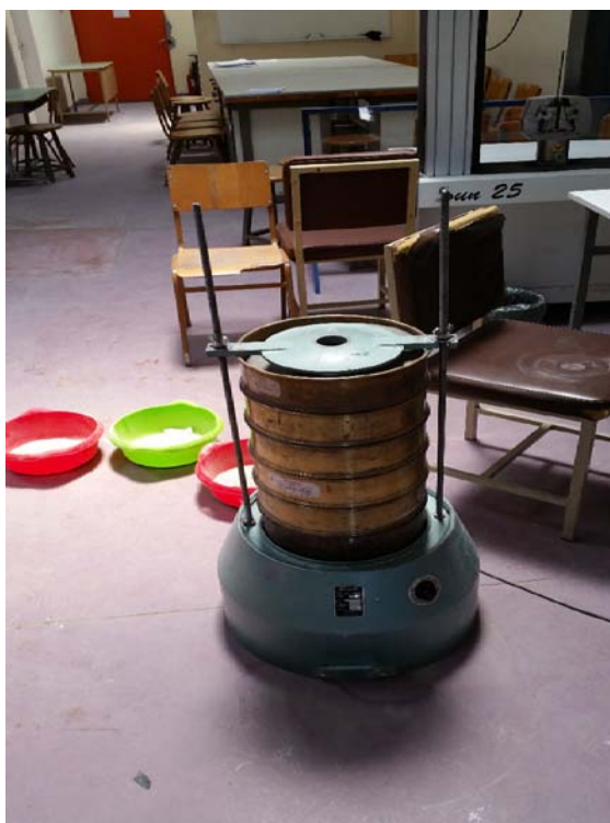
Εικόνα 21.Μηχανή κοσκίνων για το διαχωρισμό της άμμου
