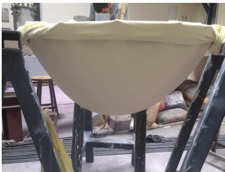
Εικόνα 40.Τελικό βέλτιστο σχήμα παραβολικού τόξου
