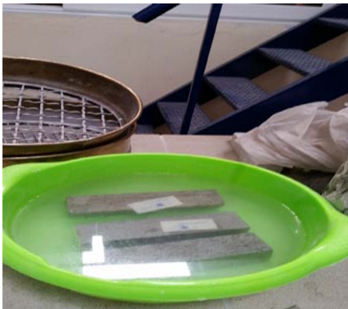
Εικόνα 27. Ωρίμανση δοκιμίων σε νερό
