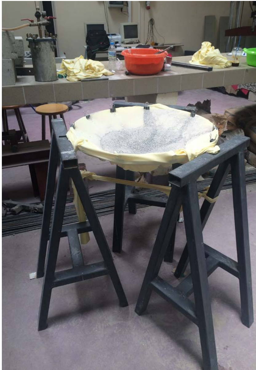
Εικόνα 36.Σταδιακό ισογέμισμα της ελαστικής βάσης με άμμο
