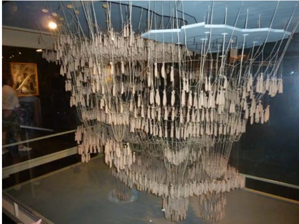
Εικόνα 5.Βέλτιστοποιημένο σχήμα με σημειακά φορτισμένες αλυσίδες
