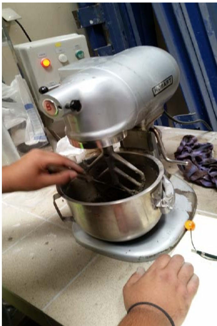
Εικόνα 25.Ανάδευση τσιμεντοπολτού για το τελικό κονίαμα
