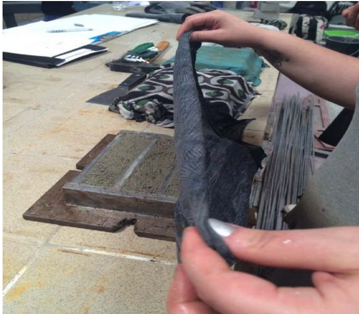
Εικόνα 26. Τοποθέτηση βρεγμένων πανιών πάνω στα φρέσκα δοκίμια για την αποφυγή αφυδάτωσης και αστοχίας αυτών
