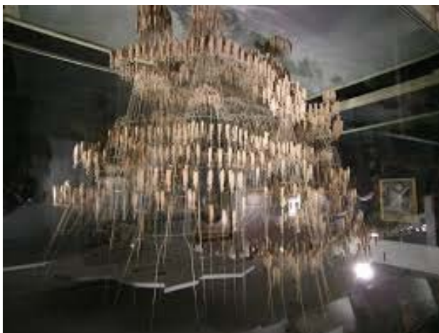
Εικόνα 6.Ανεστραμένο τελικό σχήμα αλυσίδων με φορτίσεις
