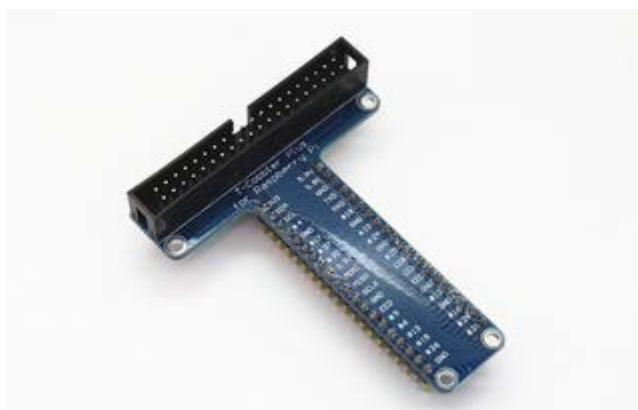
Εικόνα 21 T-Cobbler Plus - GPIO
