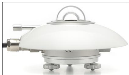
Σχήμα 1.34: πυρανόμετρο καταγραφής της ολικής ηλιακής ακτινοβολίας
