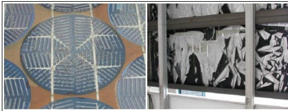
Σχήμα 2.91: παραδείγματα γήρασης ΦΒ συλλέκτη όπου φαίνεται (α) ο αποχρωματισμός των ΦΒ στοιχείων και (β) η διάβρωση του πλαστικού υλικού προστασίας της πίσω όψης
