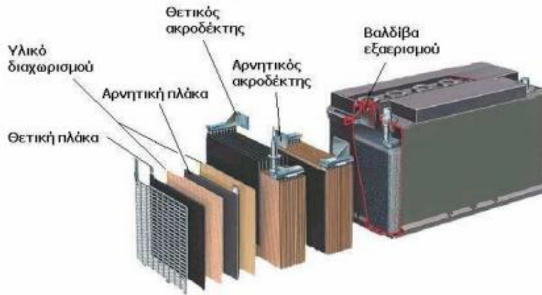
Σχήμα 3.25: κατασκευαστική δομή τυπικού συσσωρευτή μολύβδου εμπορίου
