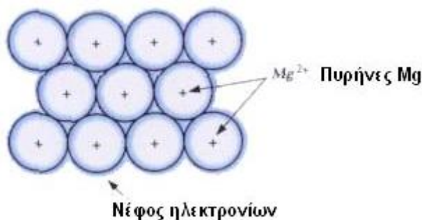
Σχήμα 2.12: μεταλλικός δεσμός στο Μαγνήσιο (Mg) - οι πυρήνες Μαγνησίου περιβάλλονται από νέφος ηλεκτρονίων
