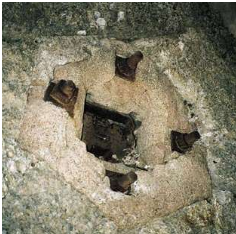
Εικόνα 41 Σωζόμενη άνω μυλόπετρα, ή παναριά. Ο ομφαλός για τέλεια σύνδεση με τις μυλόπετρες είναι εξαγωνικός και η γούλα τετραγωνική. Συνήθως είναι κυκλική. Διακρίνεται πως η χελιδόνα παγιώνεται στη μυλόπετρα με τέσσερα μπουλόνια. Τρεις μεταλλικές στεφάνες περισφίγγουν τα λίθινα κομμάτια που αποτελούν τη μυλόπετρα
