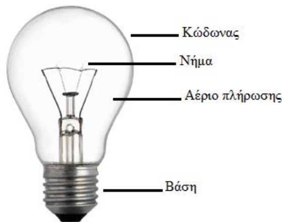
Σχήμα 2.3.1: Τα βασικά στοιχεία που δομούν έναν λαμπτήρα πυρακτώσεως.
