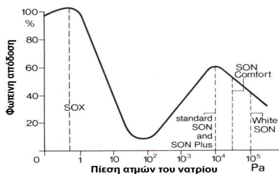
Σχήμα 2.4.30: Η επίδραση της πίεσης των ατμών του νατρίου στη φωτεινή απόδοση των λαμπτήρων νατρίου υψηλής πίεσης.
