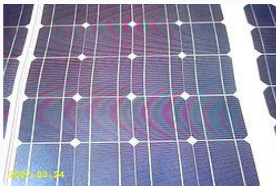
Εικόνα 10. Φωτοβολταϊκά από μονοκρυσταλλικό πυρίτιο
