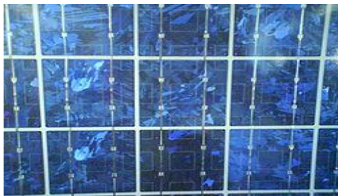
Εικόνα 9. Φωτοβολταϊκά από πολυκρυσταλλικό πυρίτιο
