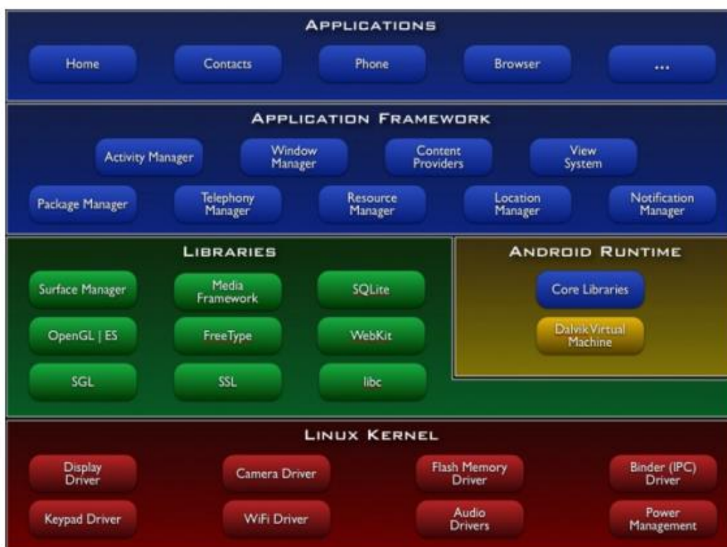
Εικόνα 3.5: Η δομή της αρχιτεκτονικής του λειτουργικού συστήματος Android
