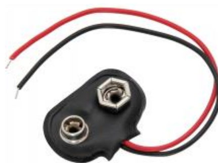
Εικόνα 6.2: Αντάπτορας σύνδεσης Arduino με εξωτερική τροφοδοσία
