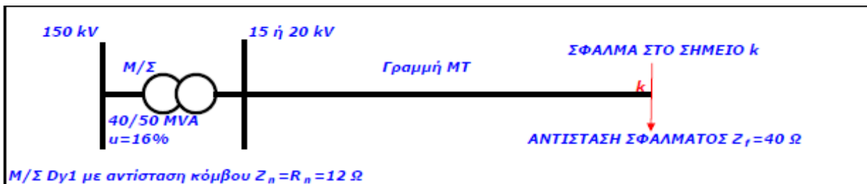
Σχήμα 4.2: Ενδεικτική απεικόνιση γραμμής κορμού ΜΤ με σφάλμα στο σημείο k
