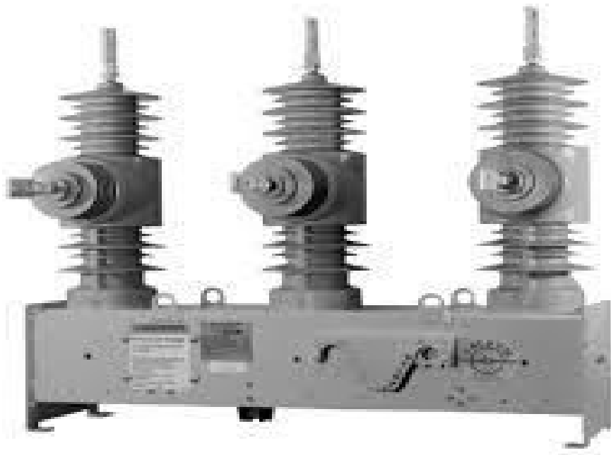
Εικόνα 2: Διακόπτης Αυτομάτου Επαναφοράς εξωτερικού χώρου, 20kV, 630A, στερεάς μόνωσης με διακοπή σε φιάλες κενού. Φέρει ηλεκτρονόμους υπερέντασης φάσεων-γης και εκτελεί κύκλο λειτουργίας πτώσεων-επαναφορών
