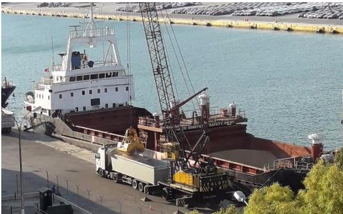
Εικόνα 4: Ο δεύτερος τρόπος χύδην εκφόρτωσης караβιού μέσω ειδικού κάδου εκφόρτωσης
