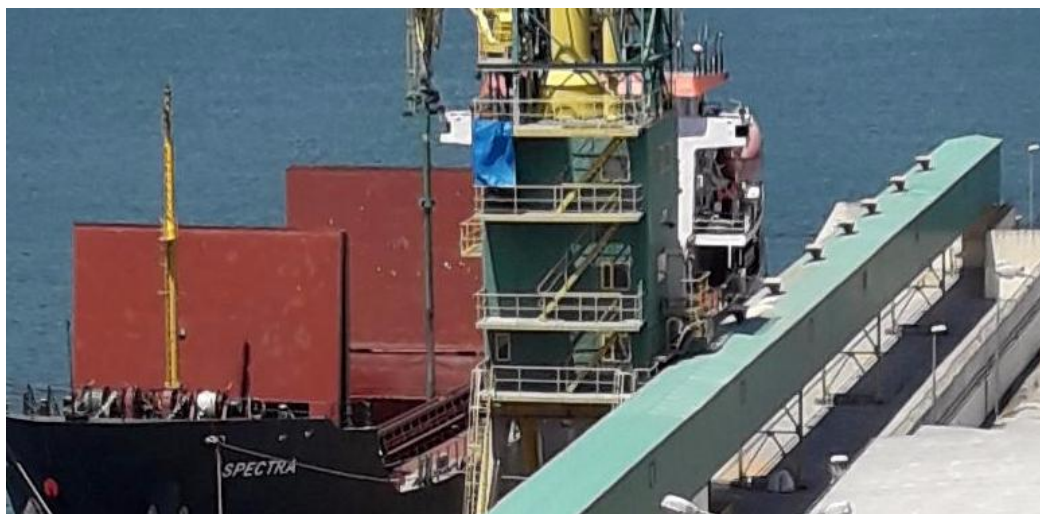
Εικόνα 3: Ο πρώτος τρόπος χύδην εκφόρτωσης καραβιού με χρήση μπούμας
