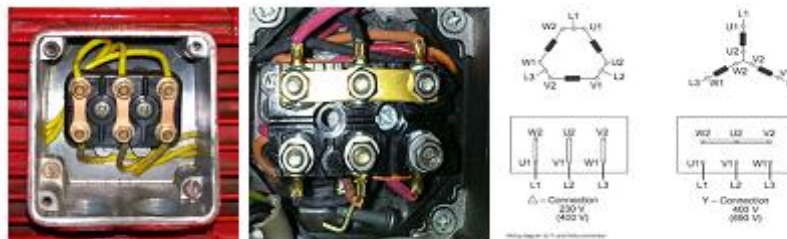
Εικόνα 30: Πραγματική και θεωρητική απεικόνιση συνδεσμολογίας τριγώνου και αστέρα
