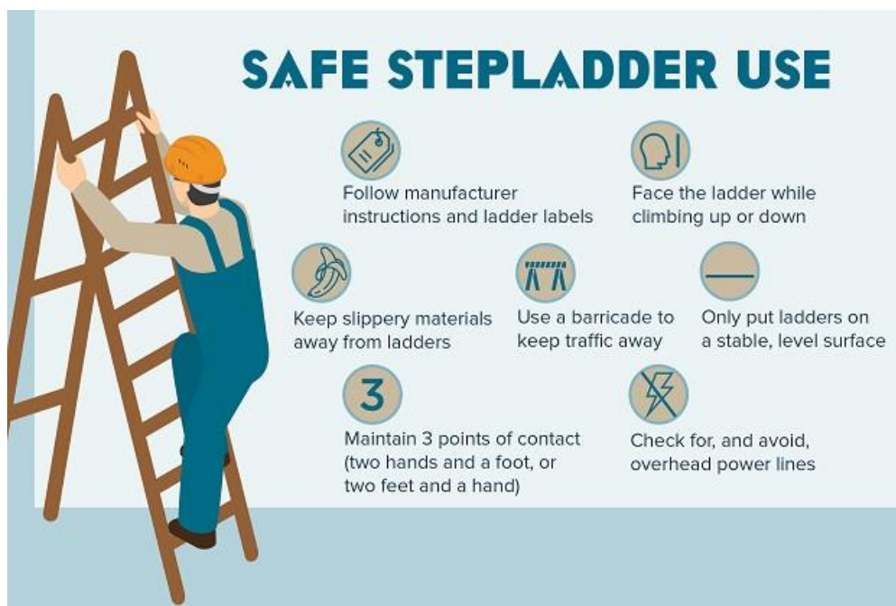
Σχήμα 5.8: Ορθή χρήση φορητής σκάλας [ https://blog.dol.gov/2017/02/21/climbing-top-ladder-safety ]
