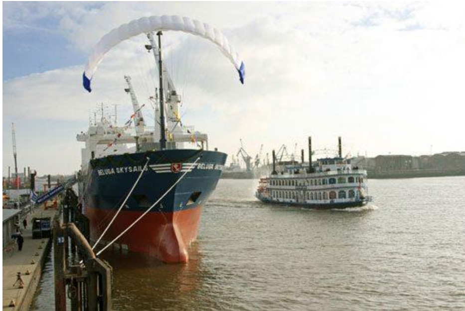
Figure 5.34 Το 400-foot Beluga SkySails, το πρώτο φορτηγό πλοίο που χρησιμοποίησε kite
