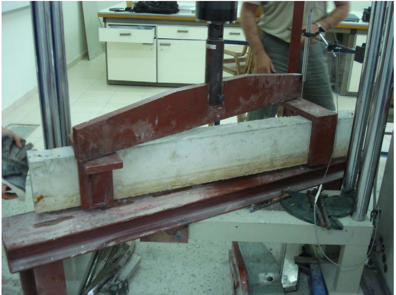
Εικόνα 5. τελευταίος έλεγχος πριν το πείραμα, η τοποθέτηση του LVDT
