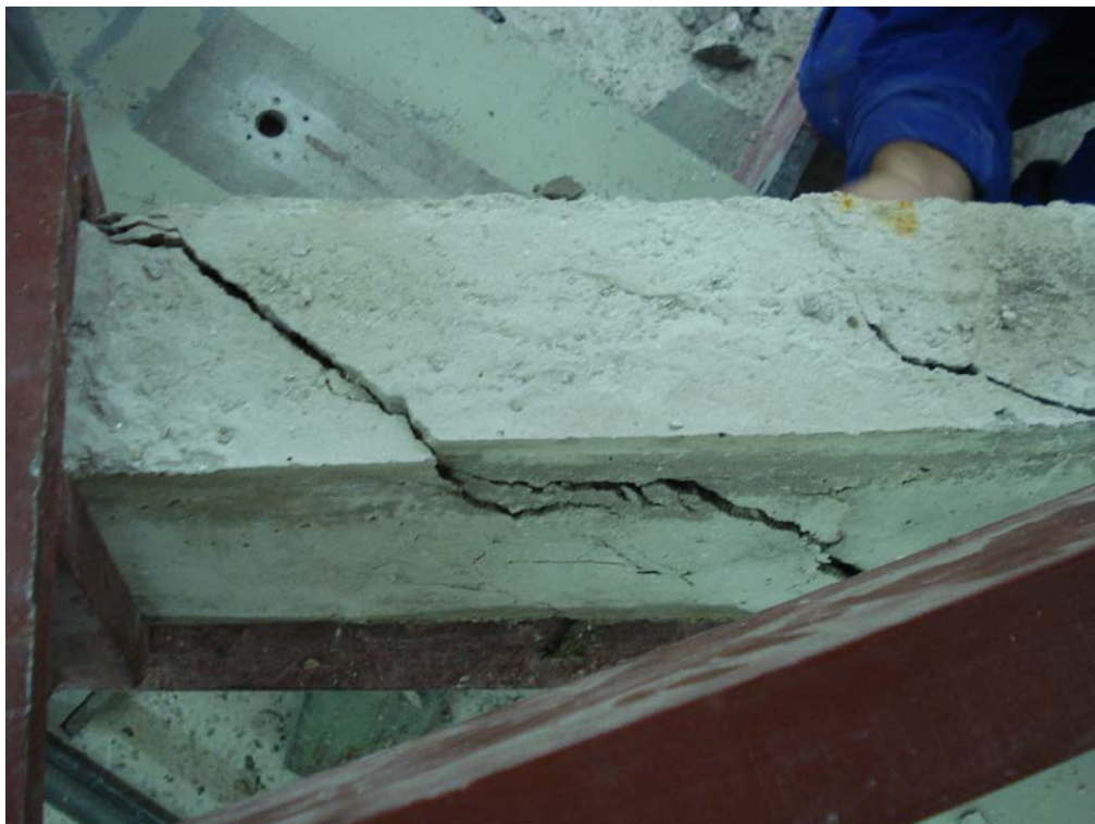
Εικόνα 9 λεπτομέρεια ρωγμες γωνίας 45^\circ προερχόμενες από τη στρεπτική καταπόνηση
