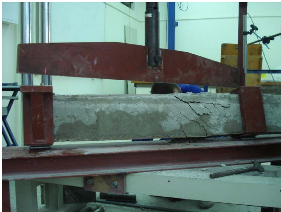
Εικόνα 7. εμφάνιση ρωγμών 45^\circ κατά τη διάρκεια της καταπόνησης
