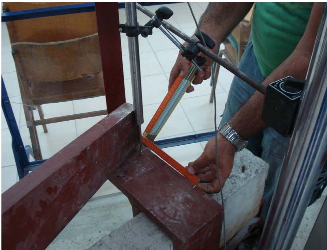
Εικόνα 4. Λεπτομέρεια μετρήσεων και υπολογισμών κατά την τοποθέτηση του δοκαριού στη μηχανή στρέψης
