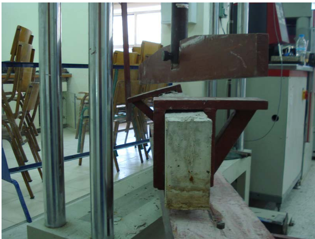
Εικόνα 11 παρατήρηση μετά το πείραμα της γωνίας που έχει σχηματιστεί στο δοκάρι.
