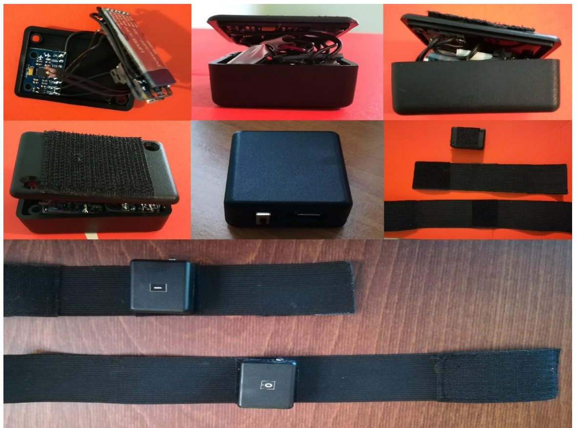
Εικόνα 3.25: Τοποθέτηση κυκλώματος στο κουτί και τελική μορφή παρουσίασης
