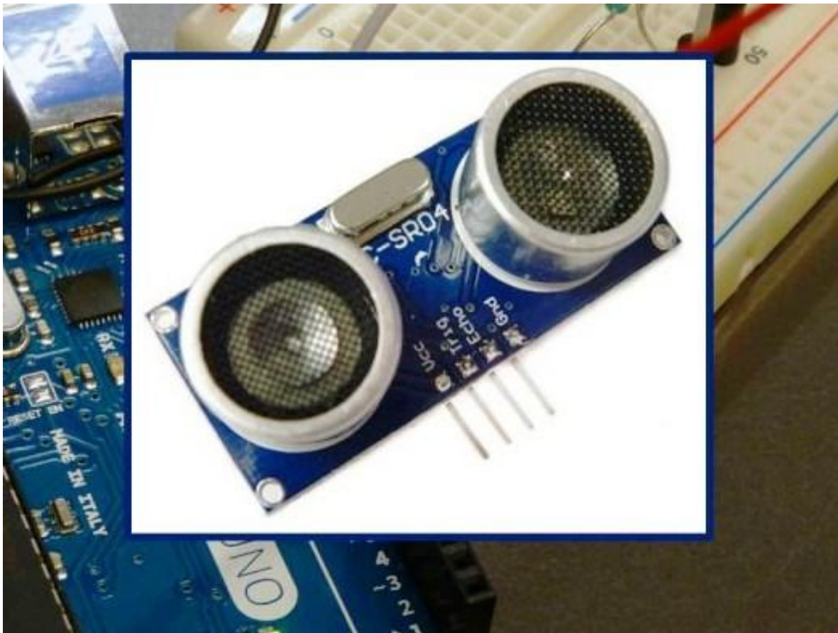
Εικόνα 56 Ο αισθητήρας υπερήχων HC-SR04. [15]
