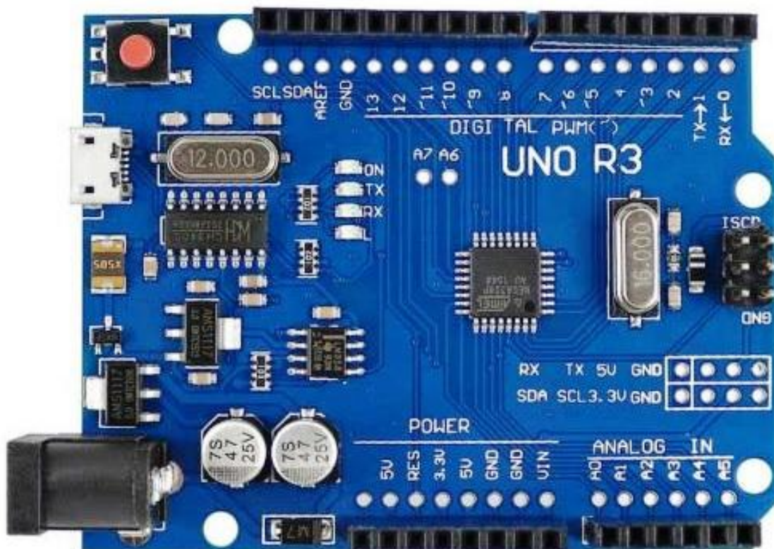
Εικόνα 52 Η πλακέτα του Arduino UNO ATmega328. [12]
