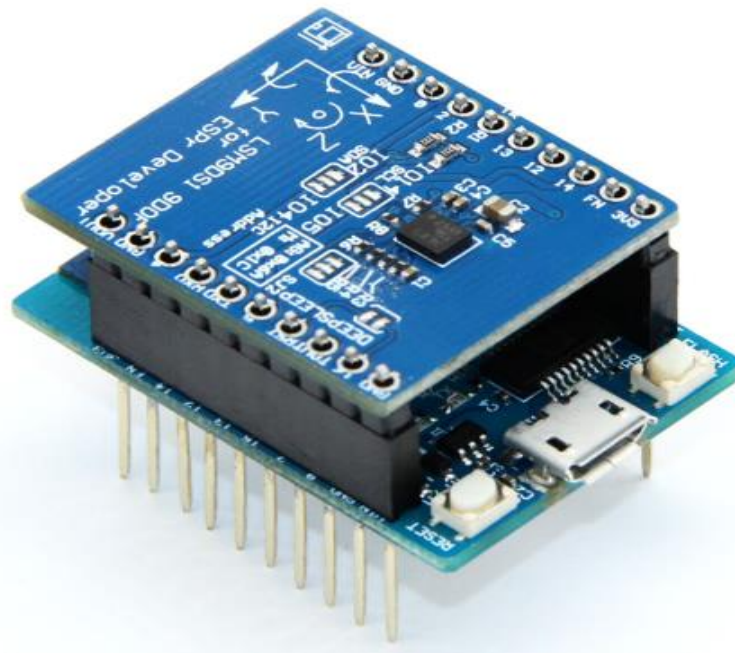
Εικόνα 1.4.1 : Wearable συσκευή μέτρησης άλματος και επιτάχυνσης.
