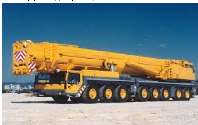
Εικόνα 5.13 - Μεγάλος αυτοκίνητος γερανός Liebherr
