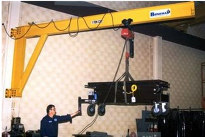
Εικόνα 5.9 - Περιστρεφόμενοι γερανοί τοίχου (Shuangpeng)
