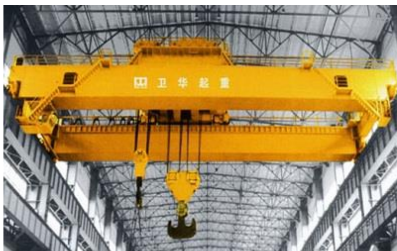
Εικόνα 5.1 – Γερανογέφυρα διπλού φορέα με επικαθήμενο βαρουλκοφορείο
