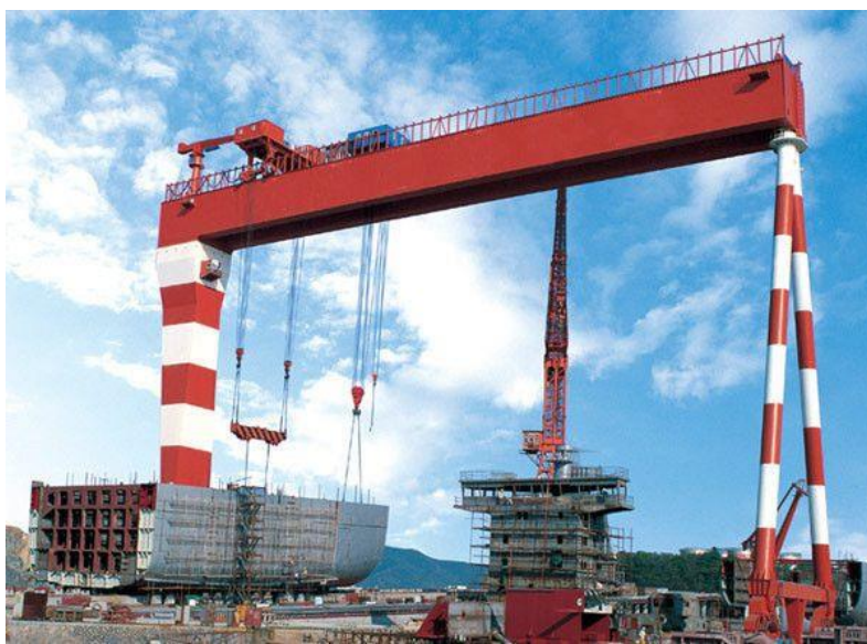
Εικόνα 5.7 - Γερανός Ναυπηγείου για την μεταφορά τμημάτων πλοίων
