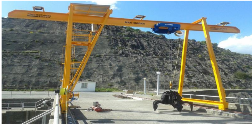
Εικόνα 5.4 – Γέφυρα με δύο πυλώνες μονού φορέα και κρεμαστό βαρουλκοφορείο για μεταφόρτωση χύδην υλικών.
