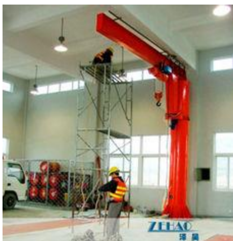
Εικόνα 5.8 - Περιστρεφόμενος γερανός κολώνας (SHUANGPENG)
