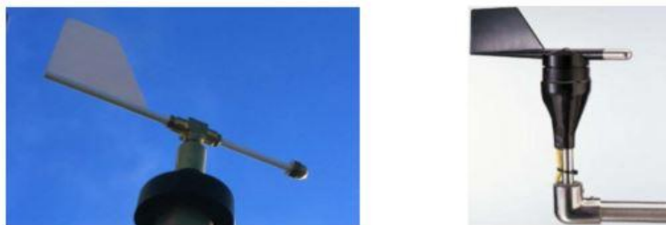
Εικόνα 23: Ανεμοδείκτες [Πηγή: Καλατζής, 2008]
