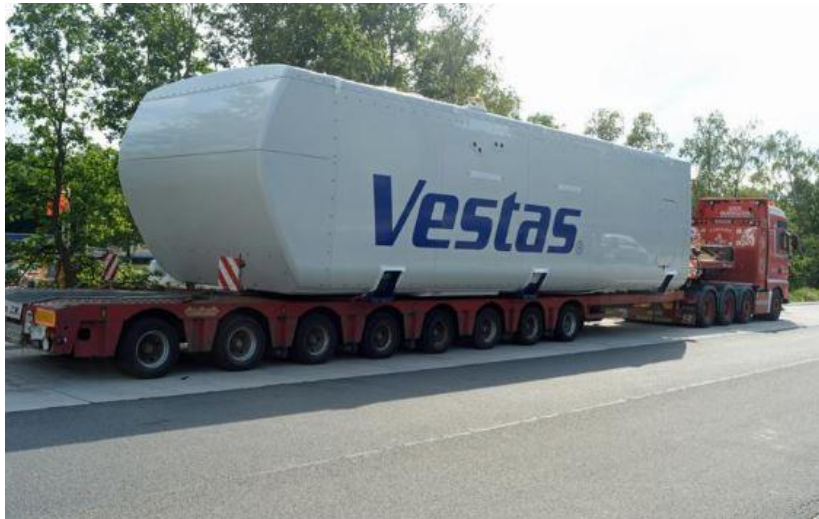
Εικόνα 41: Άτρακτος ΑΓ της εταιρίας Vestas [Πηγή: www.greentechlead.com ]
