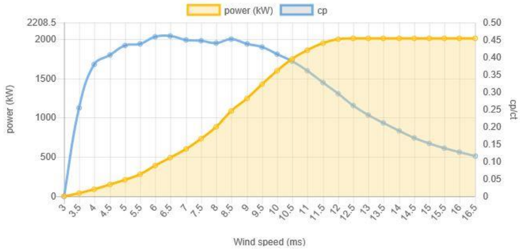
Εικόνα 82 : Διάγραμμα ισχύος Vestas V90 [Πηγή: https://en.wind-turbine-models.com/ ]
