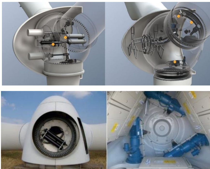
Εικόνα 64: Αριστερά υδραυλικό - δεξιά ηλεκτρικό σύστημα ρύθμισης βήματος [Πηγή: www.ifm.com & M. Karimirad, 2014]
