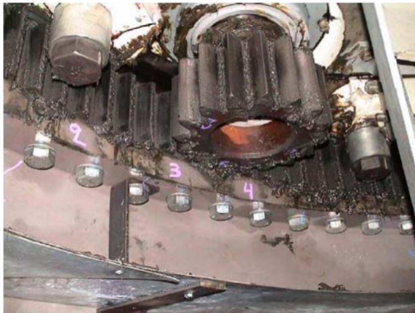
Εικόνα 47: Γρανάζι ηλεκτροκινητήρα στην οδοντωτή στεφάνη της ατράκτου [Πηγή: Καλατζής, 2008]
