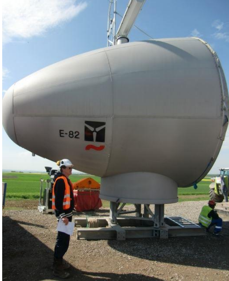
Εικόνα 42: Ατρακτος Α/Γ E-82 της εταιρίας Enercon [Πηγή: http://www.interwind.nl/finder/enercon-e82-23mw-germany/ ]
