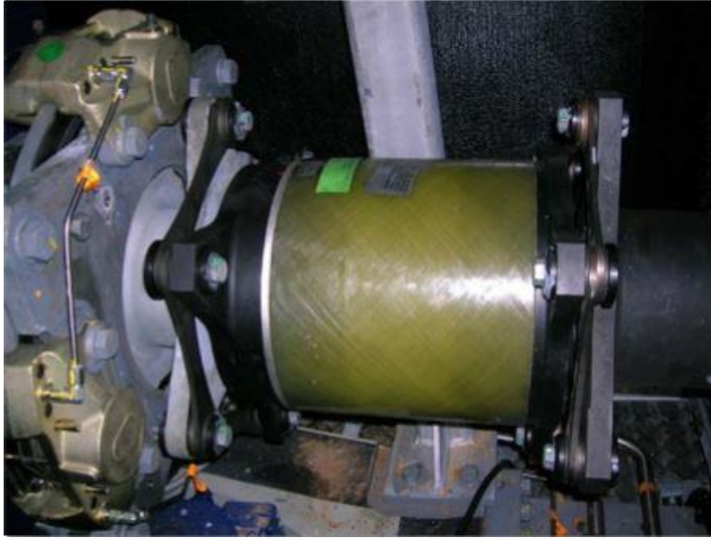
Εικόνα 52: Άξονας υψηλής ταχύτητας στην έξοδο του πολλαπλασιαστή στροφών [Πηγή: Καλαντζής, 2008]
