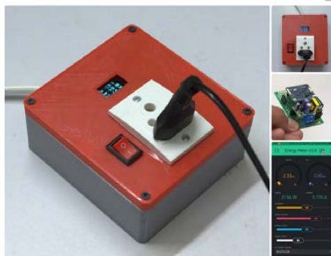
Εικόνα 105 : Έξυπνος Μετρητής Ρεύματος
