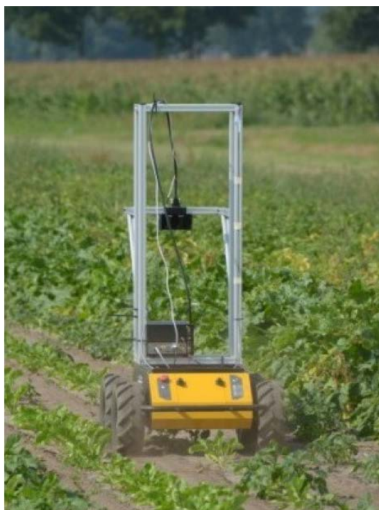
Εικόνα 57 : Ρομποτικό Όχημα Ελέγχου Φυτών Πατάτας
