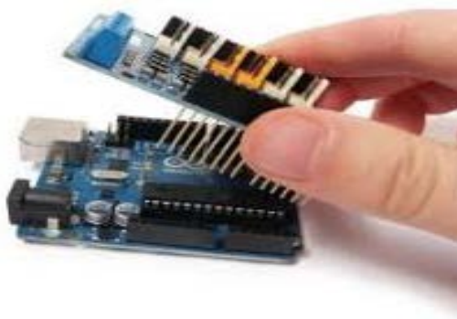
Εικόνα 79 : Τοποθέτηση Arduino Shield
