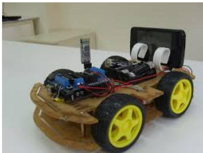
Εικόνα 44 : Ρομποτικό Όχημα Με Μικροελεγκτή Arduino (ΑΤΕΙ Πειραιά, 2014)
