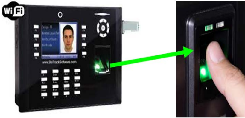
Εικόνα 30 : Έλεγχος Προσώπων Κατά Την Είσοδο Με Τη Βοήθεια Δαχτυλικού Αποτυπώματος
