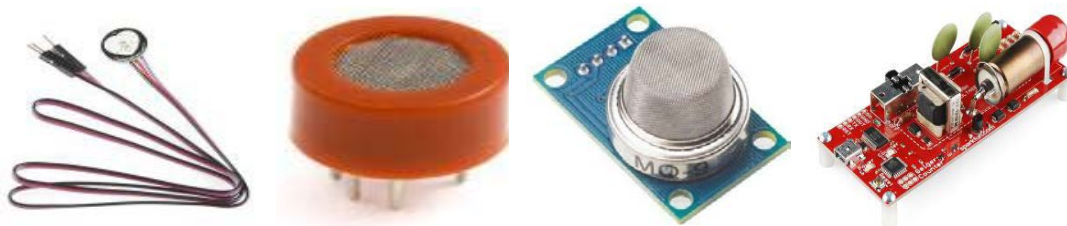
Εικόνα 91 : Αισθητήριο Παλμομέτρησης Καρδιάς, Αισθητήριο Ανίχνευσης Αλκοόλ Αναπνοής, Αισθητήρας Αερίου Μονοξειδίου Άνθρακα, Αισθητήριο Ραδιενέργειας
