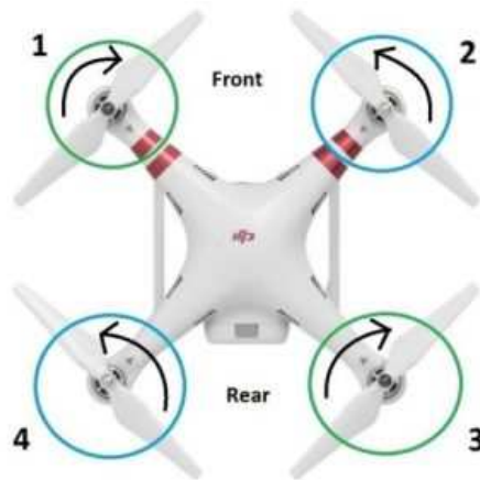
Σχήμα 5 : Οι περιστροφές στους έλικες του τετρακόπτερου.
