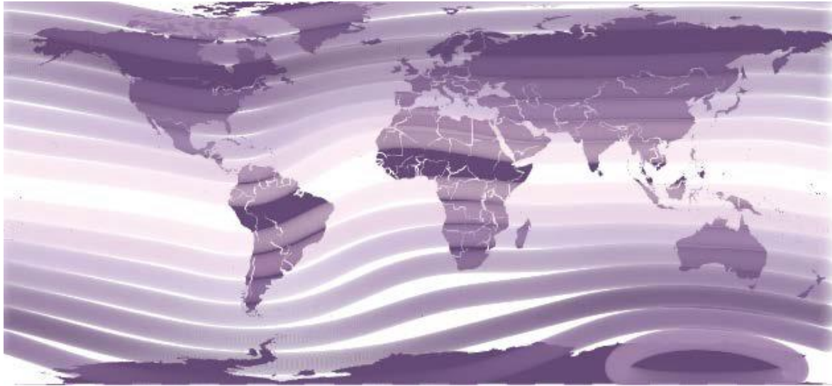
Εικόνα 2-14. Οι ζώνες του μαγνητικού γεωγραφικού πλάτους είναι χρωματικά κωδικοποιημένες από το πρότυπο του σχετικού κινδύνου από τις ακραίες γεωμαγνητικές θύελλες. Σκούρο και ανοιχτό μοβ αντιπροσωπεύουν περιοχές του υψηλότερου και χαμηλότερου κινδύνου, αντίστοιχα.
