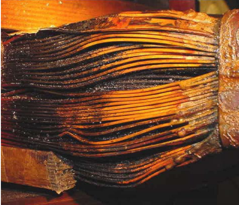
Εικόνα 2-10. Στην πρώτη εικόνα ο μετασχηματιστής υπέστη υπερθέρμανση του ηλεκτροδίου.
