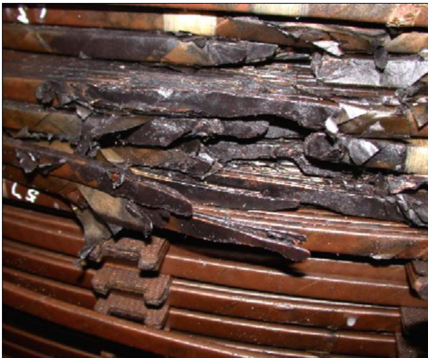
Εικόνα 2-10. Στην πρώτη εικόνα ο μετασχηματιστής υπέστη υπερθέρμανση του ηλεκτροδίου.
