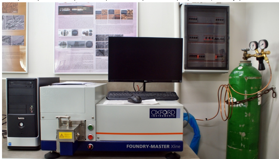
Εικόνα 6.4. Φασματογράφος οπτικής εκπομπής (OES)
