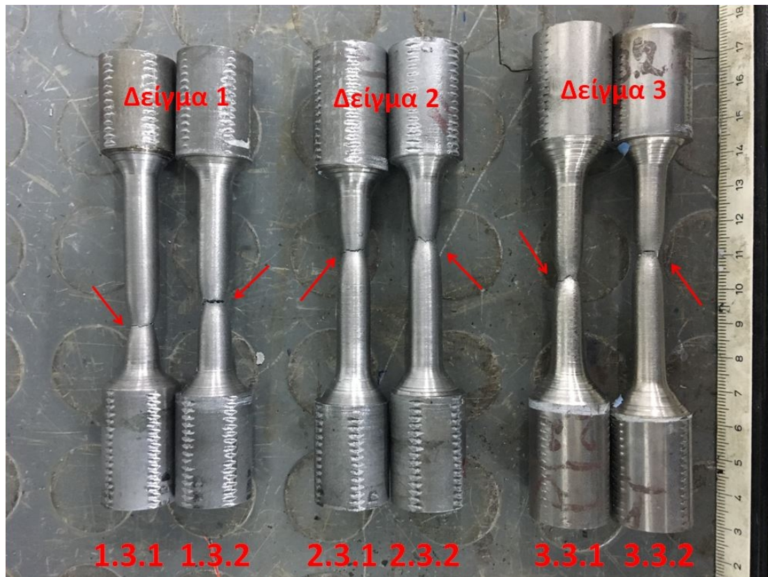
Εικόνα 6.13. Τα δοκίμια που χρησιμοποιήθηκαν στη δοκιμή εφελκυσμού (μετά τη δοκιμή, τα κόκκινα βελιάκια δείχνουν τα σημεία που έγινε η θραύση).
