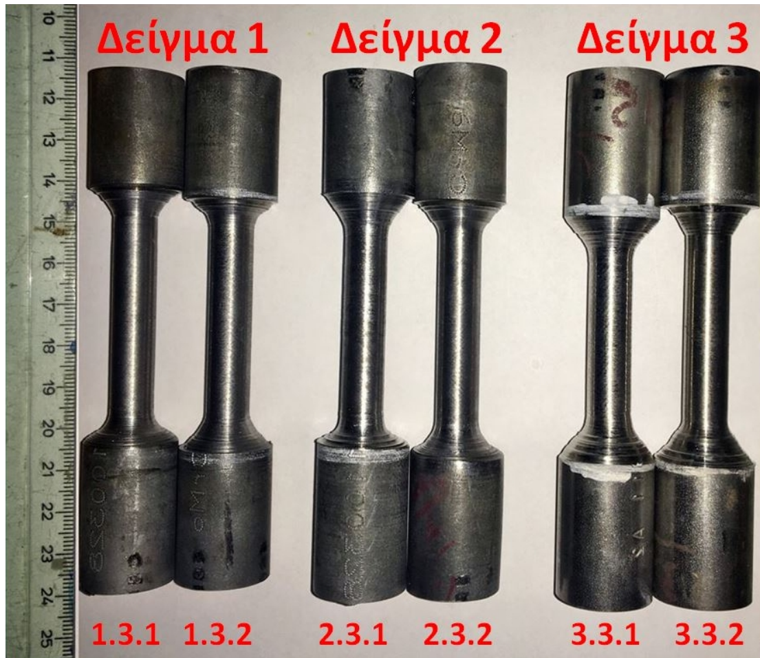
Εικόνα 6.12. Τα δοκίμια που χρησιμοποιήθηκαν στη δοκιμή εφελκυσμού (πριν τη δοκιμή).
