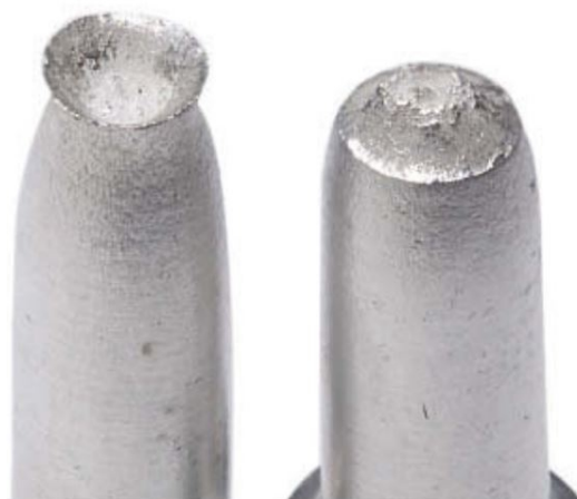
Εικόνα 3.1: Θραύση κυπέλλου – κώνου [27].
