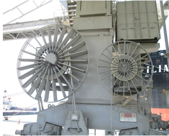
Σχήμα 3. 5: Τύμπανα στα οποία γίνεται η συλλογή του καλωδίου και το οδηγεί στο πεδίο Χαμηλής τάσης
