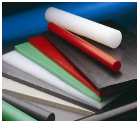
Εικόνα 8. Μέρη από πολυαιθυλένιο
