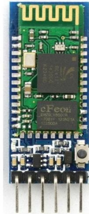
Εικόνα 3.5 Bluetooth module HC-06
