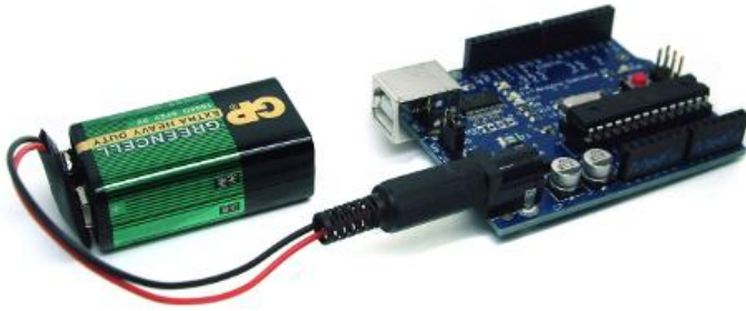
Εικόνα 1.4 Εξωτερική τροφοδοσία με 9V
