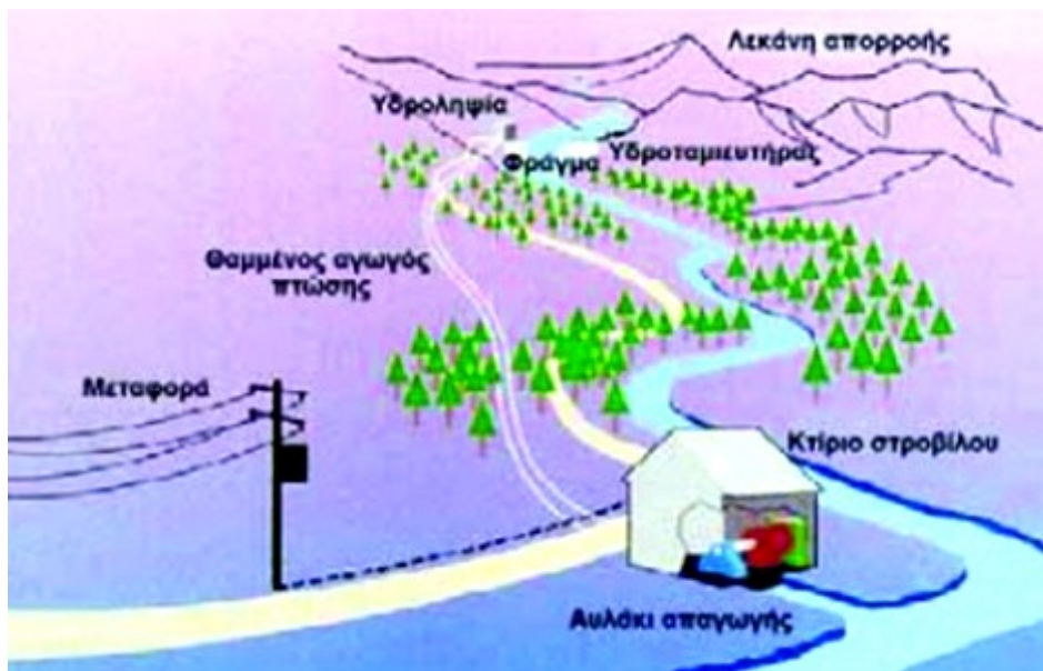
Εικόνα 1.5: Μικρός υδροηλεκτρικός σταθμός
