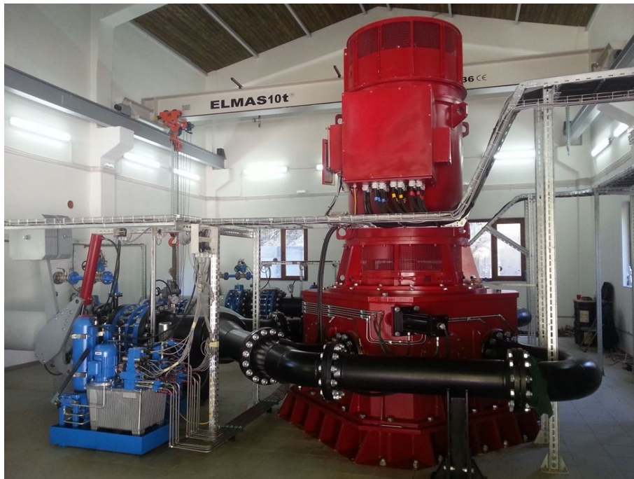
Εικόνα Π.8: Υδροστρόβιλος Pelton κάθετου άξονα 4 ακροφυσίων
