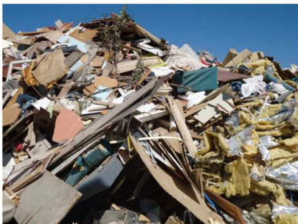
Εικόνα 4 Ανομοιογενή απόβλητα κατεδάφισης
