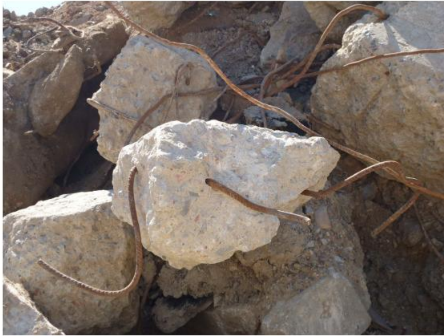
Εικόνα 10 Απόβλητα κατεδαφίσεων (οπλισμένο σκυρόδεμα (Πηγή : www.anakem.gr )
