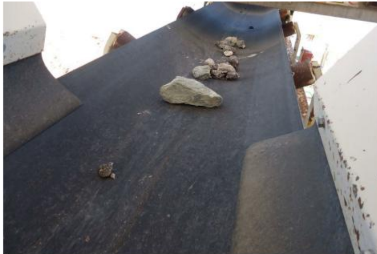
Εικόνα 8 Μεταφορά υλικών μέσω ταινιόδρομου (Πηγή : www.anakem.gr )
