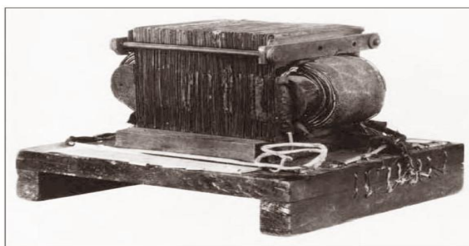
Σχήμα 2.1- Ο πρώτος πρακτικός μετασχηματιστής του William Stanley, το 1885.
