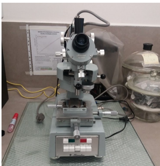
Εικόνα 5.1: Μικροσκληρόμετρο Shimadzu, Type M. (S/N: 341 – 64278) για τις ανάγκες της παρούσας πτυχιακής (Εργαστήριο: Ε.Π.Τ.ΥΛ. - Πα.Δ.Α.)
