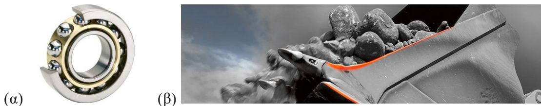
Εικόνα 1.14: Εφαρμογές χαλύβων α) για ρουλεμάν β) Αντίστασης σε τριβή [8]
