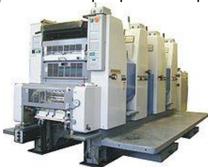
Εικ. 3. Κυλινδρική Μηχανή Εκτύπωσης OFFSET Τετραχρωμίας ( https://en.wikipedia.org/wiki/Offset_printing )
