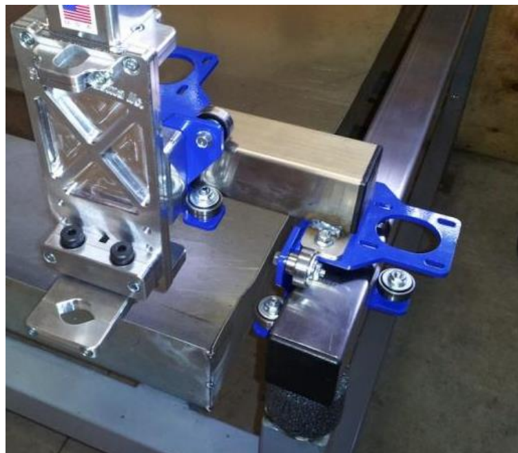
Σχήμα 2.6 Αυτοσχέδια γραμμικά έδρανα ολίσθησης
