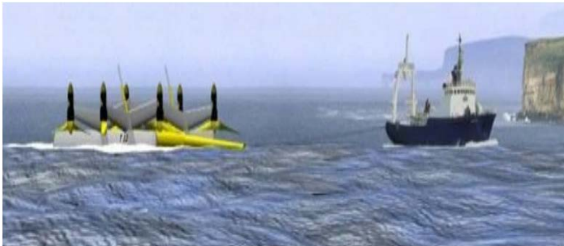
Εικόνα 24 Μικρό ρυμουλκό μεταφέρει τη συσκευή Triton 6 στην καθορισμένη θέση.
