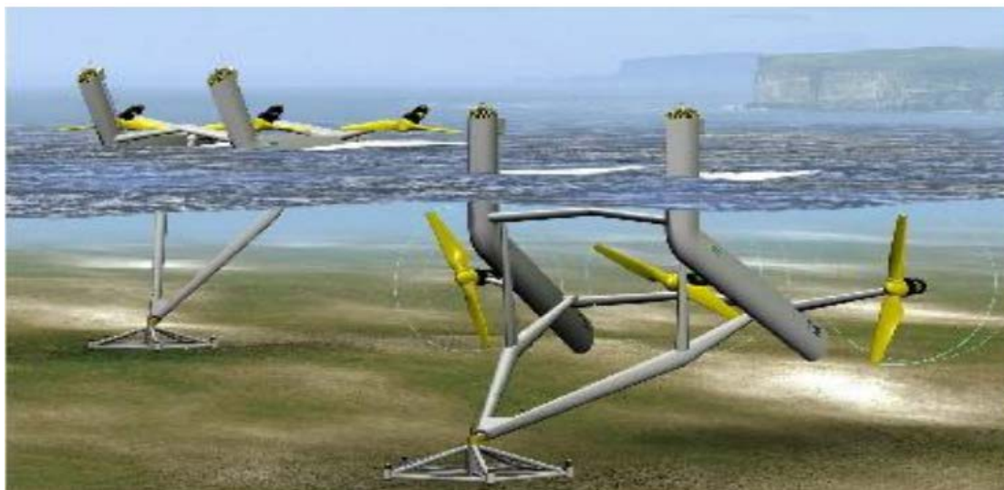
Εικόνα 22 Η συσκευή Triton 3 κατάλληλη για βάθος μεταξύ 35-55 μέτρα.
