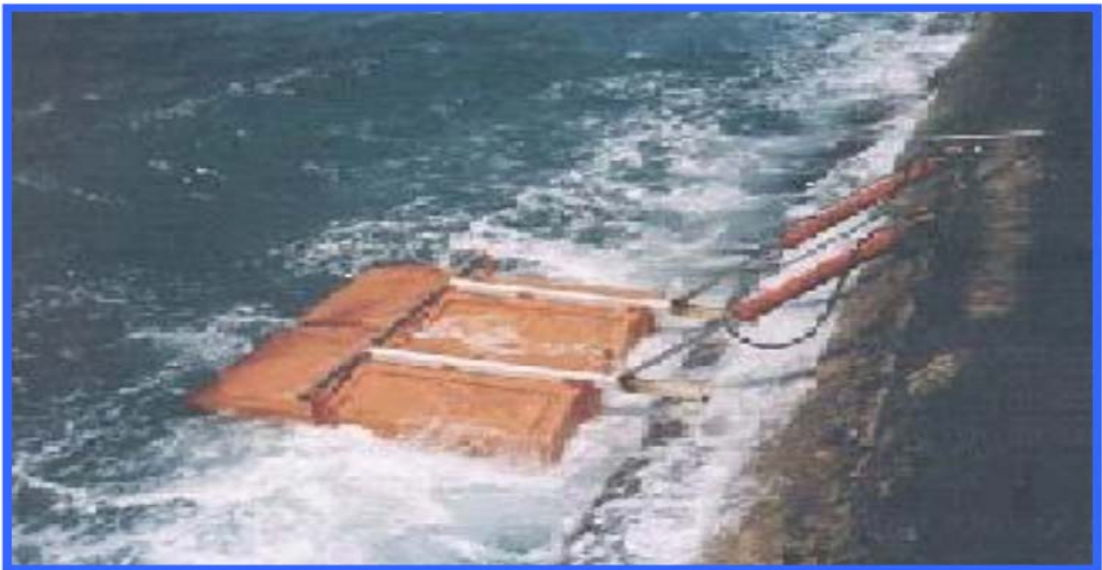
Εικόνα 34 Συσκευή θαλάσσιων ρευμάτων με υδραυλικό σύστημα.
