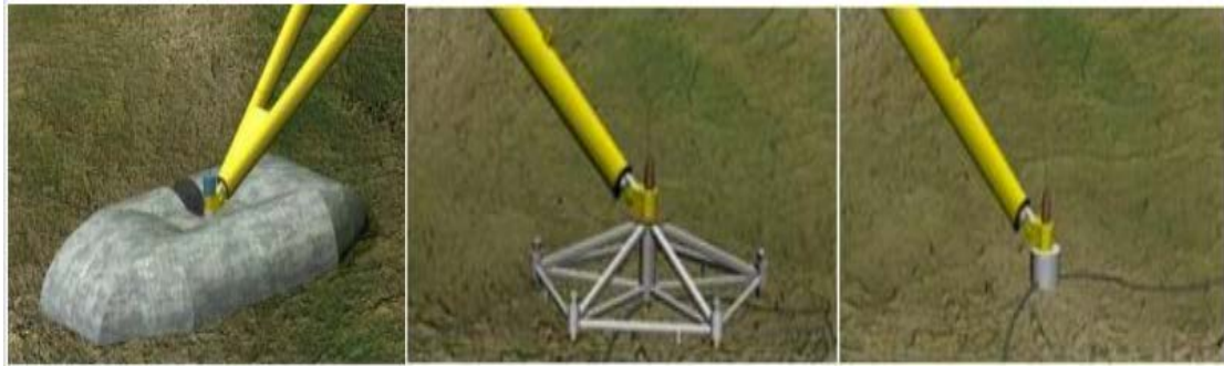
Εικόνα 23 Βάσεις στήριξης μόνο με τη βοήθεια της βαρύτητας, καρφωμένο πλαίσιο και με μόνο πάσσαλο.
