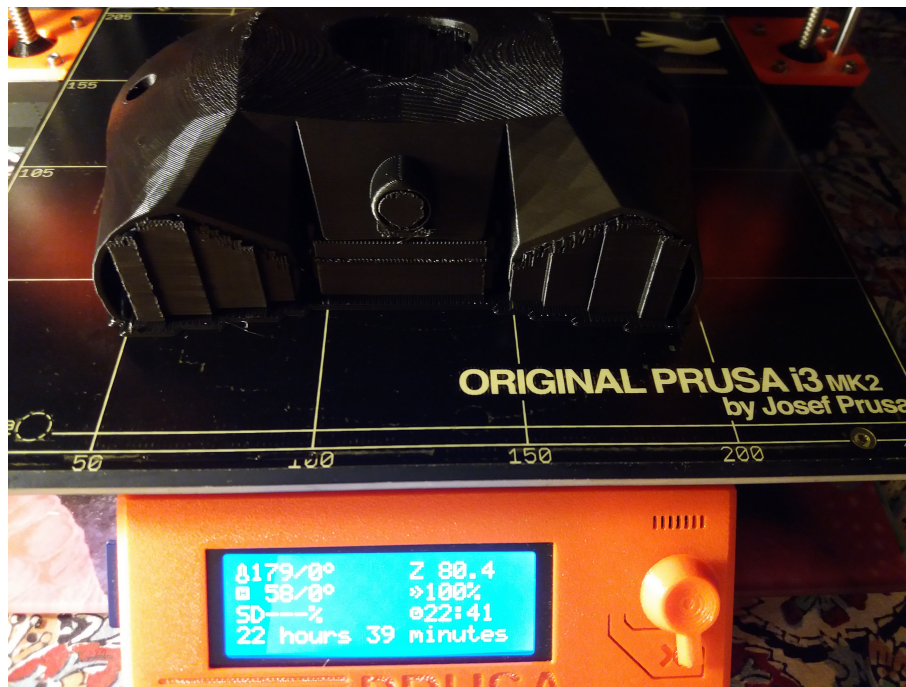
Σχήμα 4.14: Το κάτω μέρος του σαρωτή αφού τυπώθηκε
