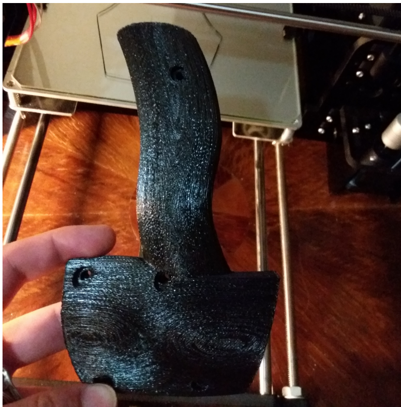
Σχήμα 4.6: Αριστερό μέρος λαβής εκτυπωμένο στον Anet A8
