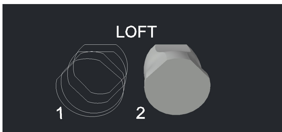
Σχήμα 3.7: Χρήση της εντολής LOFT για την δημιουργία του χώρου τροφοδοσίας
