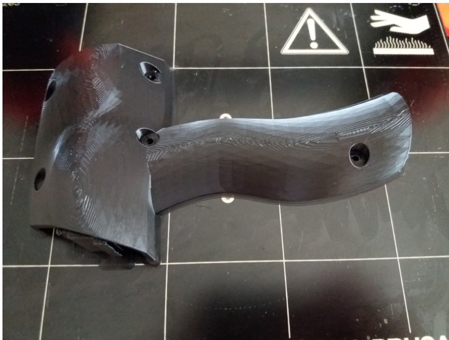
Σχήμα 4.11: Το αριστερό μέρος της λαβής αφότου τυπώθηκε
