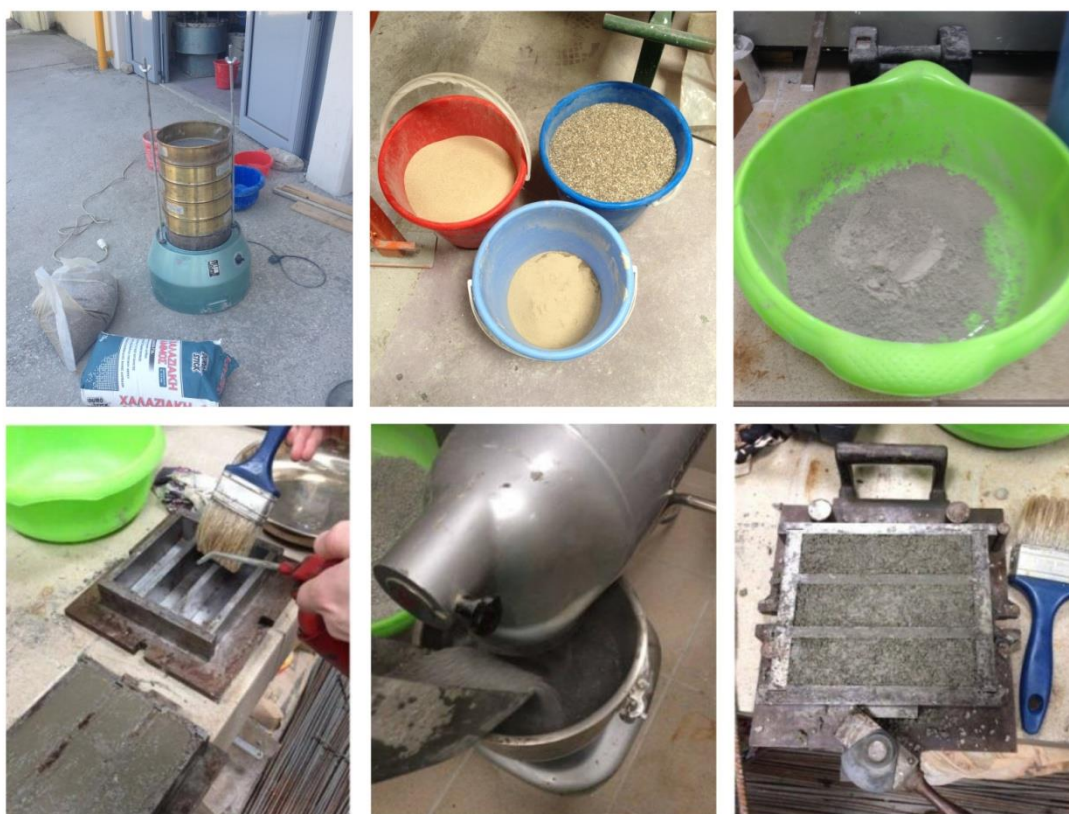
Εικόνα 15: Διαδικασία σύνθεσης κονιάματος. Από την κοσκίνιση της άμμου, στην σύνθεση της πρότυπης χαλαζιακής άμμου, την παρασκευή των δοκιμίων και την τοποθέτηση του κονιάματος στην μήτρα (καλούπι)
