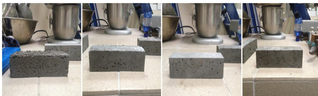
Εικόνα 19: Τα δοκίμια, ένα από κάθε μήτρα, που φτιάχτηκαν με αντικατάσταση άμμου με ποζολάνη. Από αριστερά προς τα δεξιά- Από την πρώτη μήτρα με προσθήκη 15 gr ρευστοποιητή, από την δεύτερη με προσθήκη 17 gr ρευστοποιητή, από την τρίτη με προσθήκη 19 gr ρευστοποιητή και τέλος από την τέταρτη με προσθήκη 20gr ρευστοποιητή.
