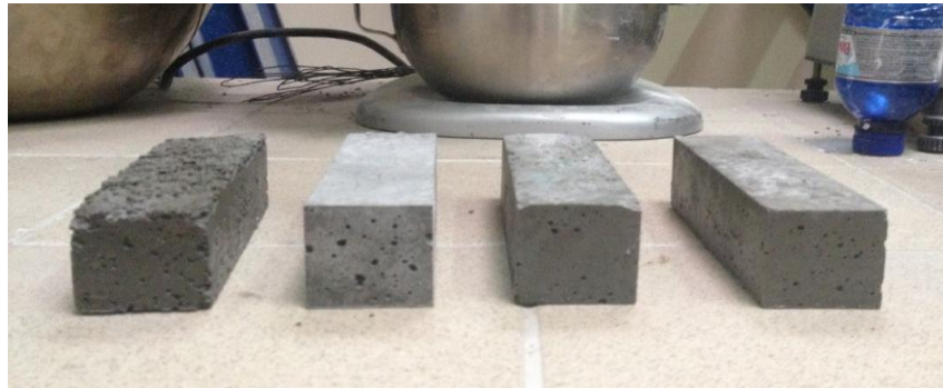
Εικόνα 18: Τα δοκίμια, ένα από κάθε μήτρα, που φτιάχτηκαν με αντικατάσταση άμμου με ποζολάνη.
