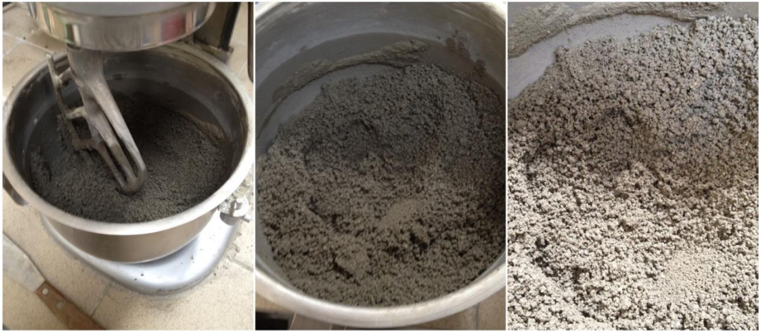
Εικόνα 17: Το μίγμα με την αντικατάσταση της άμμου με ποζολάνη και την προσθήκη 7 gr ρευστοποιητή
