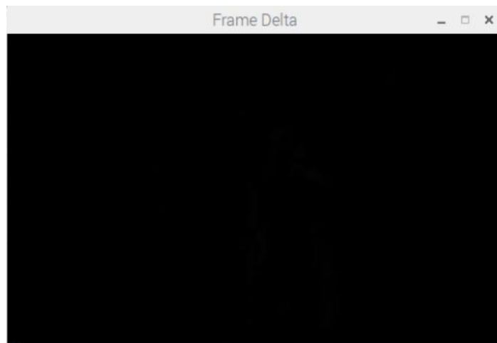
Εικόνα 23: Παράθυρο "Frame Delta" με τη χρήση της δεύτερης μεθόδου με τιμή κατωφλίου 50.
