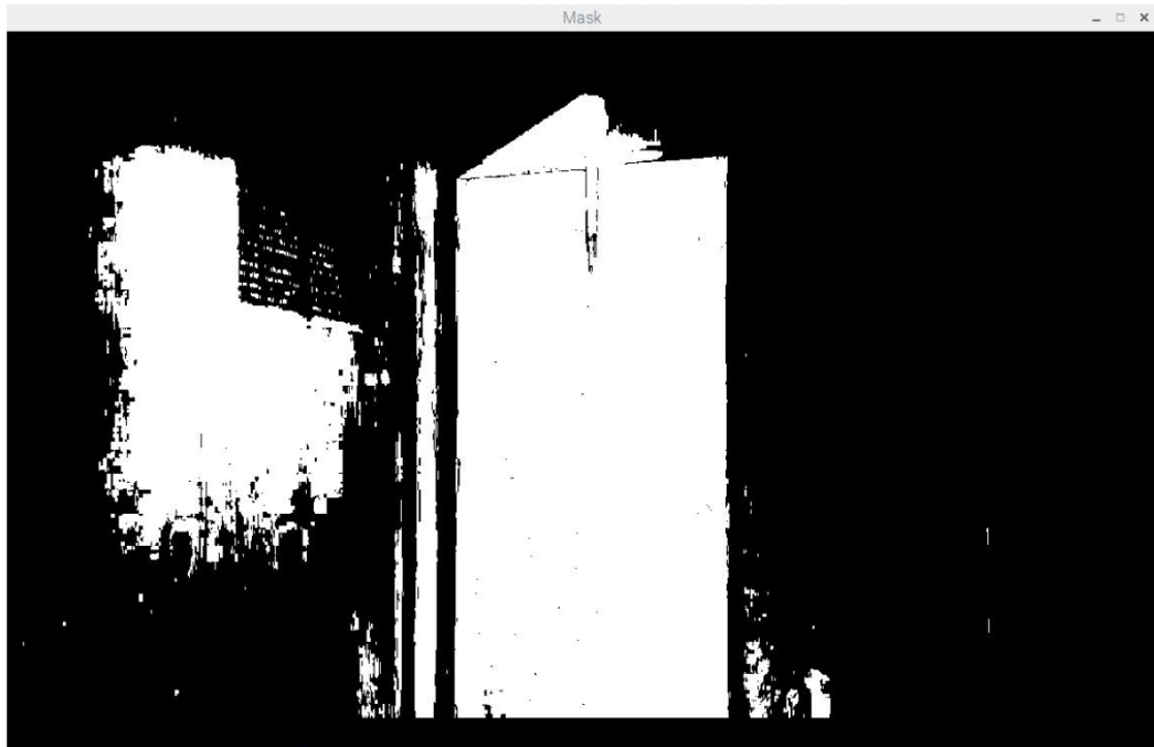
Εικόνα 28: Μάσκα με τη χρήση της συνάρτησης createBackgroundSubtractorMOG2 και detectShadows=False .
