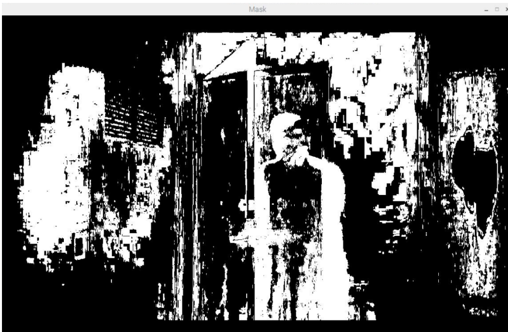
Εικόνα 29: Μάσκα με τη χρήση της συνάρτησης createBackgroundSubtractorMOG2 και detectShadows=False .(2)
