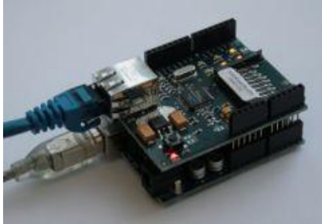
Εικόνα 11 ( Πλακέτα επέκτασης δυνατοτήτων του κύριου μικροελεγκτή )
