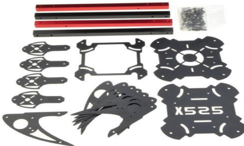
Εικόνα 8 (Επιμέρους κομμάτια του σκελετού από αλουμίνιο και ανθρακόνημα)
