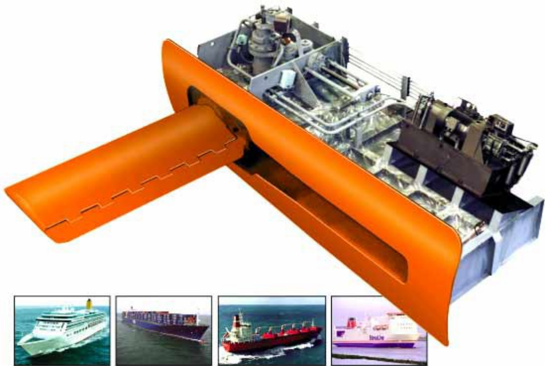
Σχήμα 7:Γενικό σύστημα σταθμιστήρα
