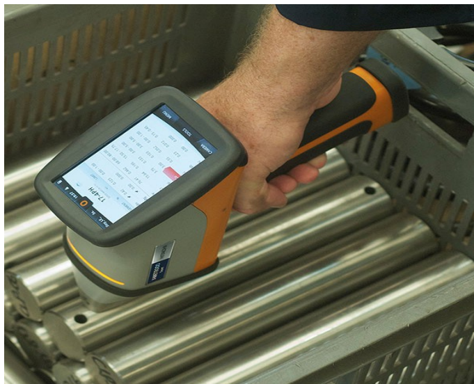
Εικόνα 11: Συσκευή ελέγχου καυσίμων και λιπαντικών – Φασματογράφος XRF X-MET8000 [32]
