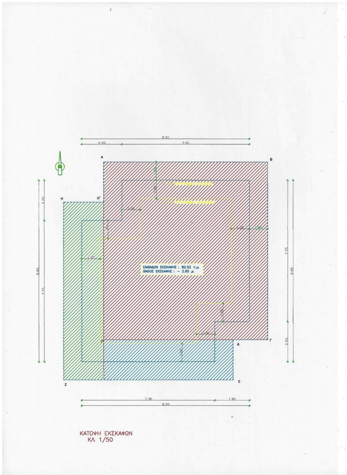
Σχέδιο 13: Προμέτρηση εκσκαφής σε βάθος 1,50 m.
