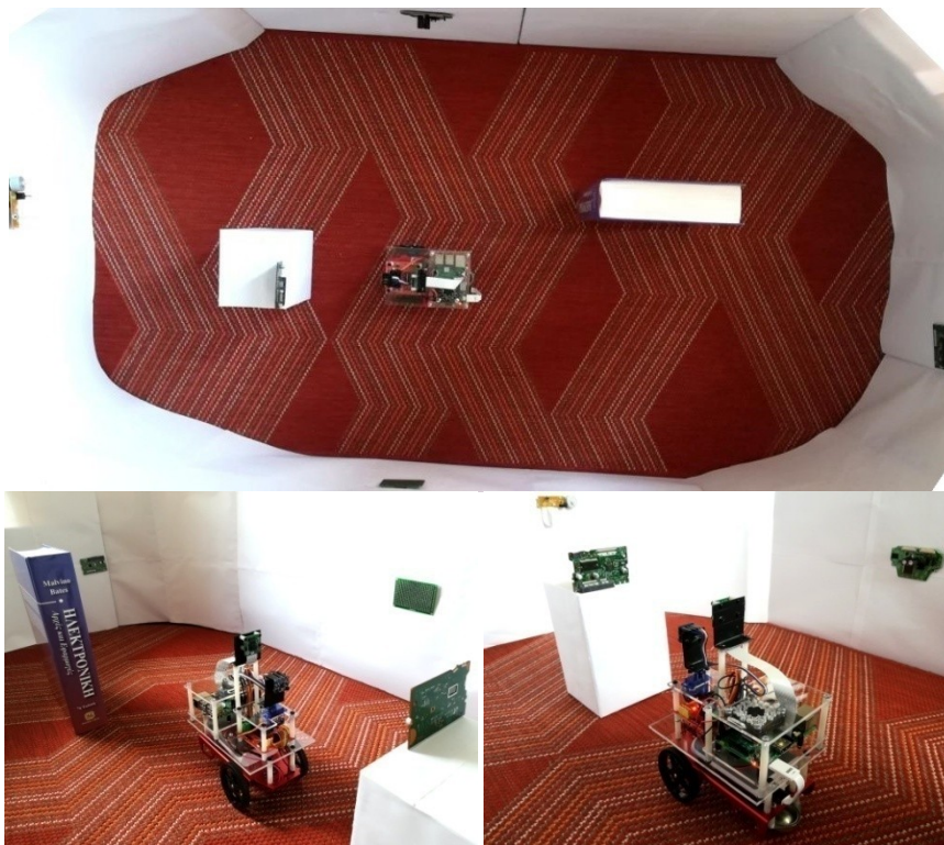
Σχήμα 7.5.2: Εντοπισμός και προσέγγιση της πλακέτας από το αυτόνομο ρομποτικό όχημα.
