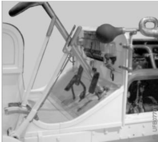
Εικόνα 9 Μηχανισμός πεντάλ και μοχλού στο Mercedes Simplex
