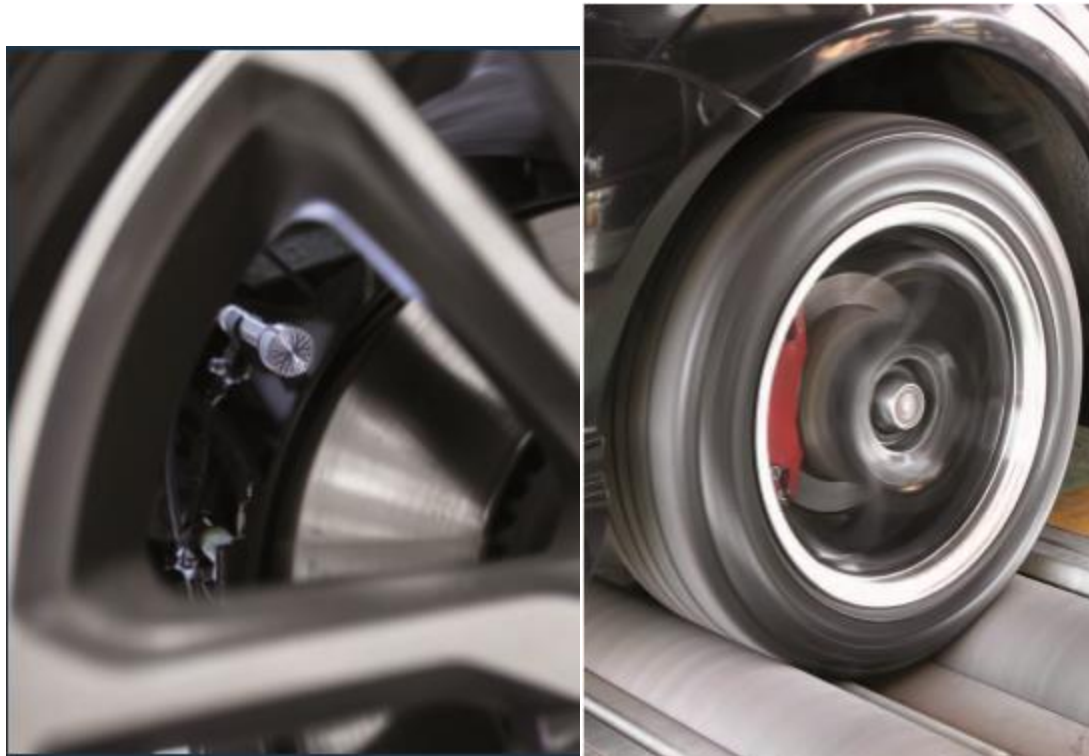
Εικόνα 40 Τοποθέτηση μικροφώνων και δοκιμή squeal δυναμομέτρου φρένου
