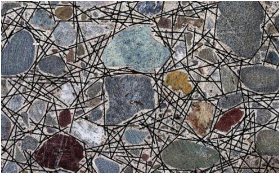
Εικόνα 4 . Απεικόνιση εργαστηριακού δείγματος από ενισχυμένο σκυρόδεμα με ίνες από ασάλι (Singh, 2017)
