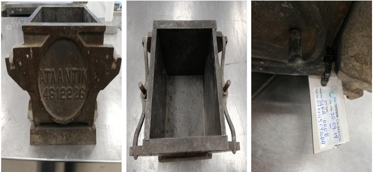
Εικόνα 4.(8,9,10) Μήτρα σκυροδέματος 15* 15*15 με πιστοποίηση
