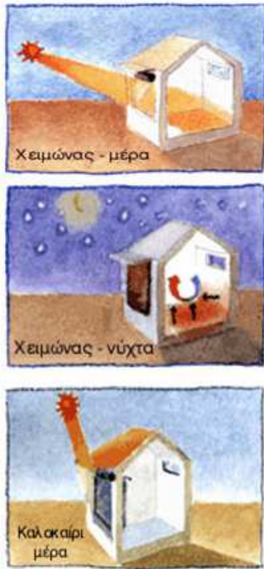
Εικόνα 3.2 : Συνεισφορά ηλιασμού το χειμώνα και αποφυγή το καλοκαίρι 12
