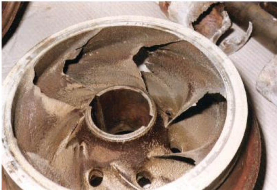
Εικ. 5.4 Απεικόνιση φθοράς μεταλλικής επιφάνειας στροφείου, λόγω σπηλαίωσης
