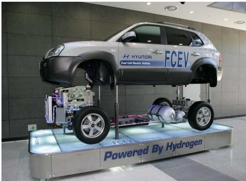
Εικόνα 2.2.2: Εφαρμογή PEM κυψέλης καυσίμου σε όχημα της Hyundai
