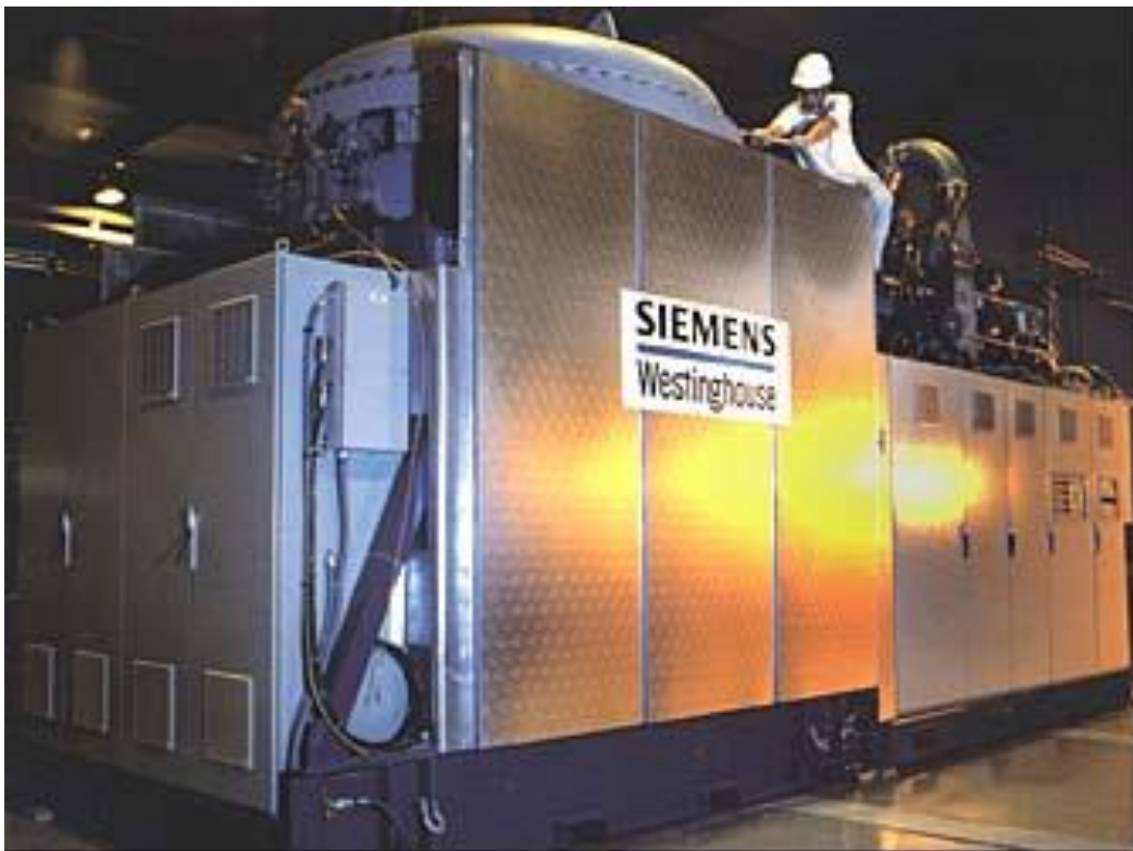
Εικόνα 2.6.2: Το σύστημα Siemens Westinghouse ισχύος 220kW αποτελούμενο από μία κυψέλη καυσίμου στερεών οξειδίων και έναν στρόβιλο
