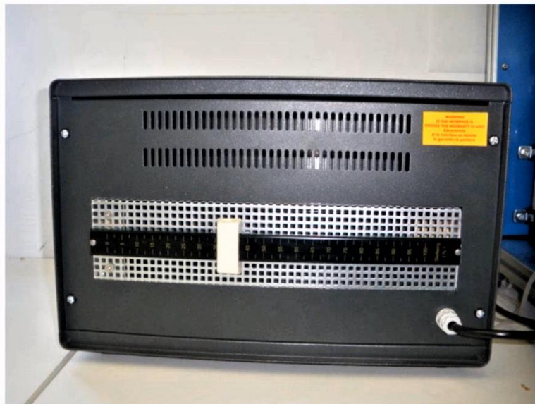
Εικόνα 4.1.2.2: Μεταβλητό Φορτίο μέσω Ροοστάτη
