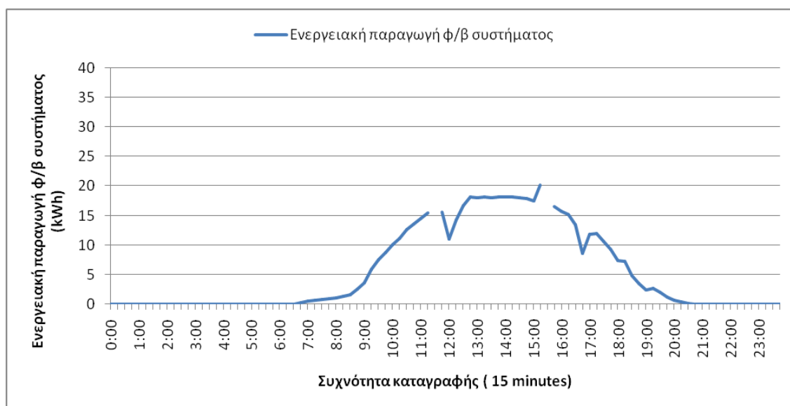
Διάγραμμα 4-2 Ημερήσια διακύμανση ενεργειακής παραγωγής φ/β συστήματος μετά τη διόρθωση των μετρήσεων (Πάρκο 1, 30-5-2011)
