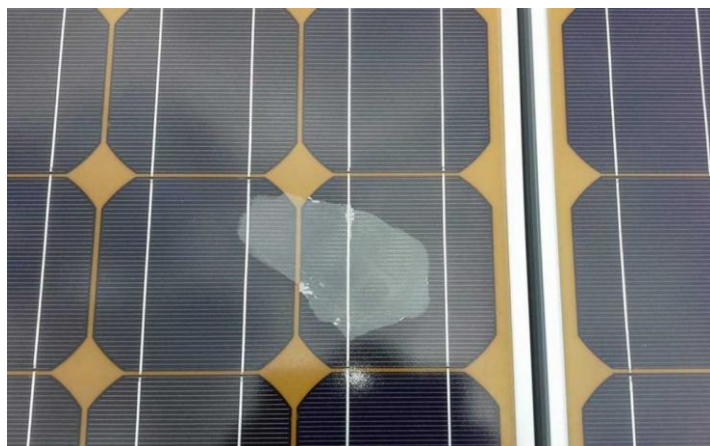
Εικόνα 2-3 Αποχρωματισμός φ/β πλαισίου Πηγή: review.solar
