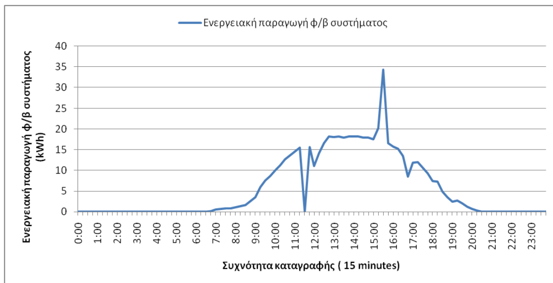
Διάγραμμα 4-1 Ημερήσια διακύμανση ενεργειακής παραγωγής φ/β συστήματος πριν τη διόρθωση των μετρήσεων (Πάρκο 1, 30-5-2011)
