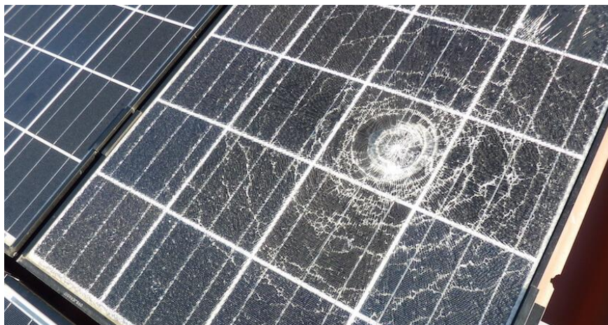
Εικόνα 2-5 Ραγισμένο γυαλί σε φ/β πλαίσιο Πηγή: hovall.com
