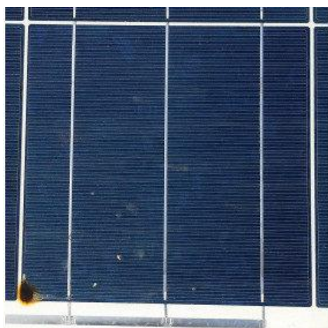
Εικόνα 2-7 Θερμές κηλίδες σε φ/β πλαίσια Πηγή: pv-magazine-usa.com
