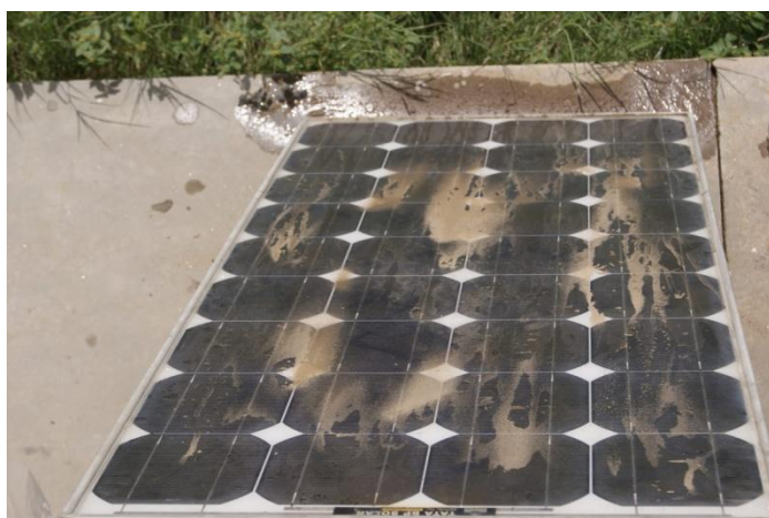
Εικόνα 2-2 Συσώρευση σκόνης στην επιφάνεια φ/β πλαισίου Πηγή: pv-magazine.com
