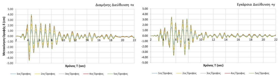
Σχήμα 5.39: Χρονοϊστορίες μετακινήσεων οροφής κτηρίου, στις δύο διευθύνσεις του, λαμβάνοντας υπόψη την ανισοσταθμία των κατακόρυφων στοιχείων της pilotis, βάση της καταγραφής του σταθμού στο Κ.Ε.Δ.Ε. (ΑΤΗ399) με προσαύξηση κατά 10%
