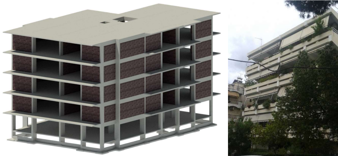
Σχήμα 3.1: Φωτορεαλιστική αποτύπωση φέροντα οργανισμού και κύρια όψη κτηρίου
