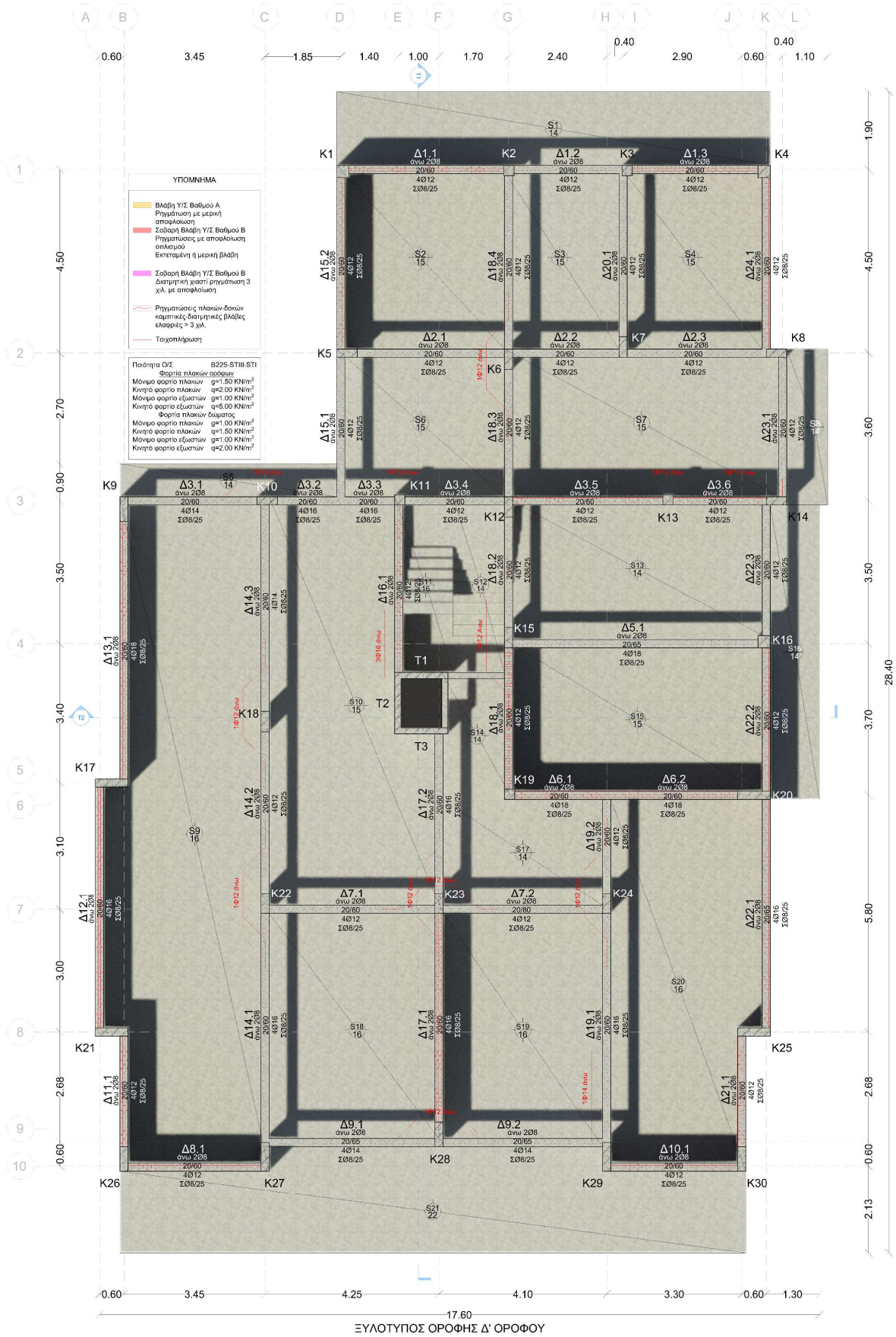
Σχήμα 3.7: Ευλότυπος Οροφής Δ' Ορόφου
