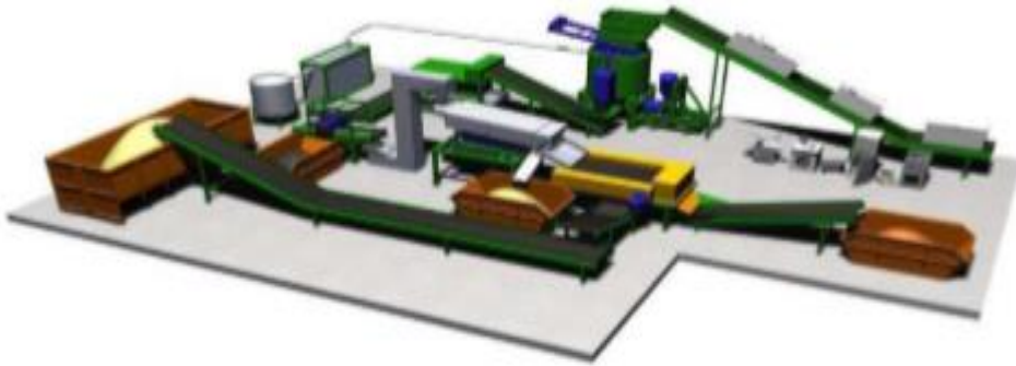
Εικόνα 12 Εργοστάσιο Ανακύκλωσης ΑΗΗΕ με τεμαχισμό διαχωρισμό[60]
